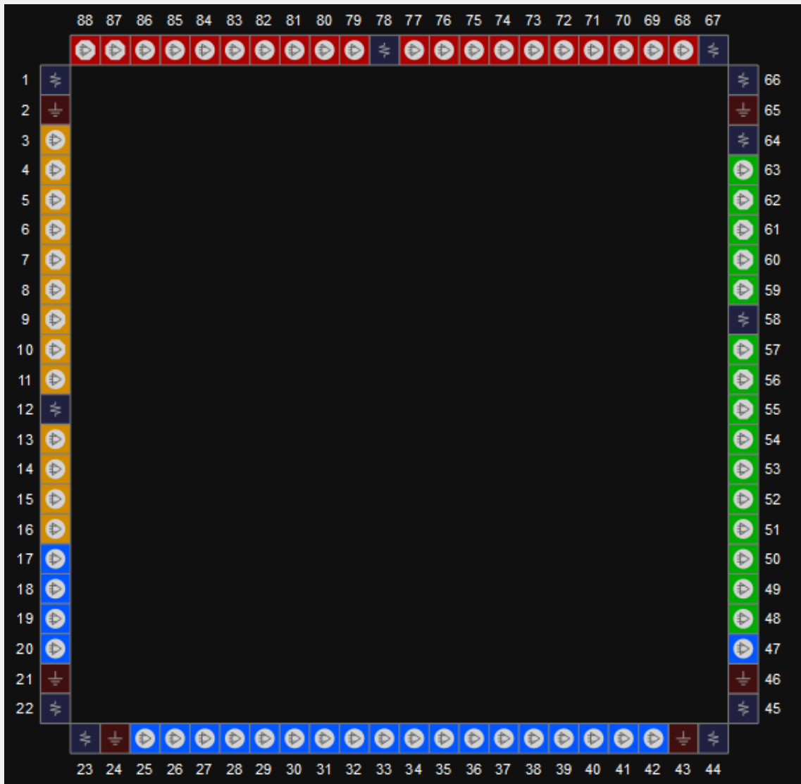
图 3-3 GW1NR-4/ GW1NR-4B 器件 QN88 封装管脚分布示意图（顶视图，内嵌 SDRAM）
