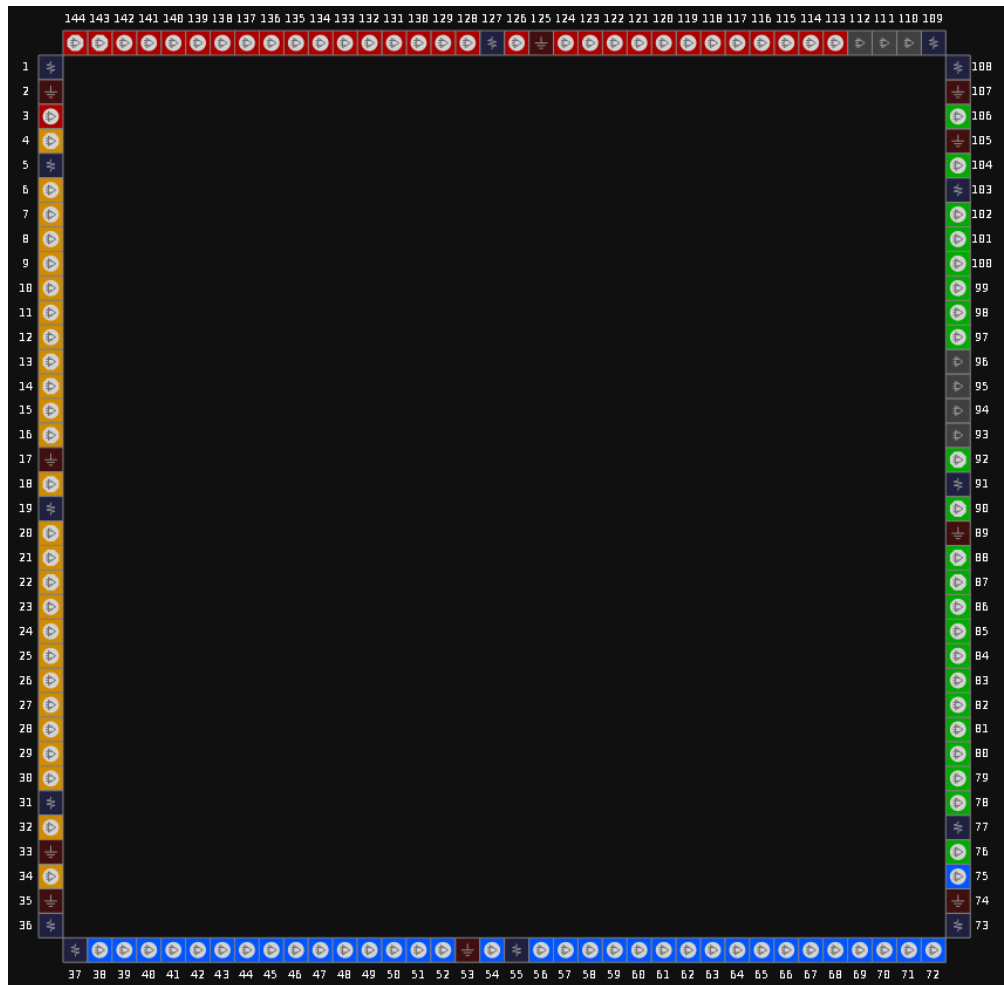
图 3-2 GW1NR-1 器件 EQ144G 封装管脚分布示意图（顶视图）
