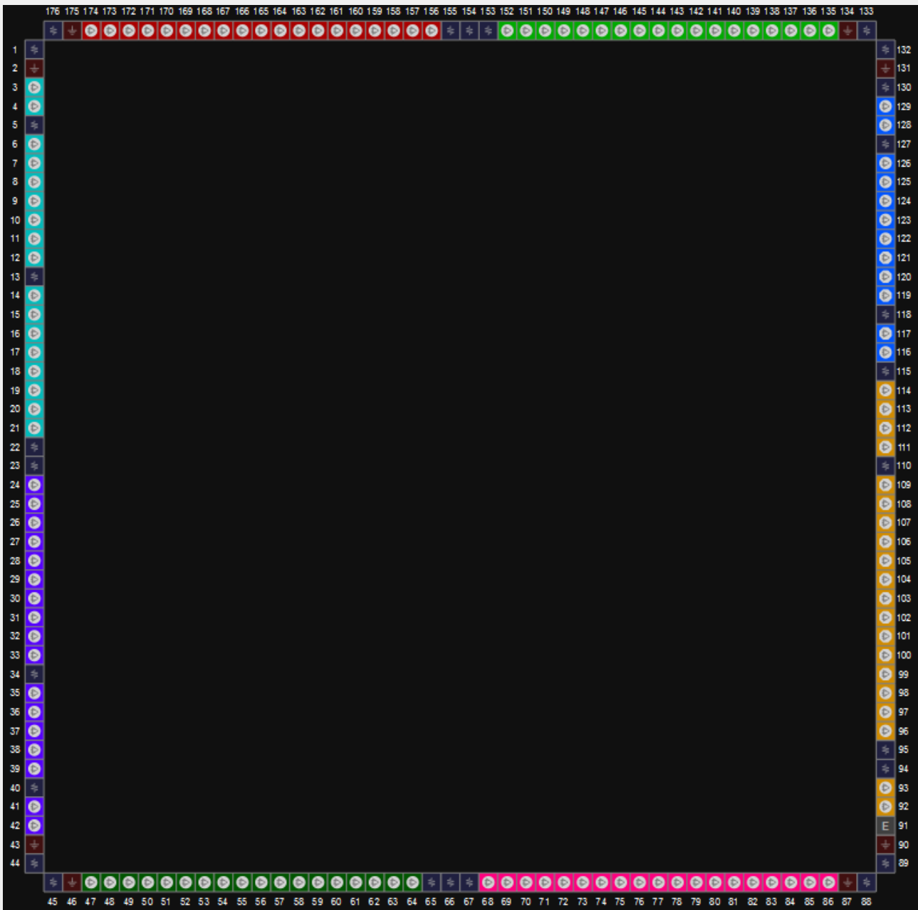
图 3-5 GW2AR-18 器件 LQ176 封装管脚分布示意图(内嵌 SDRAM)
