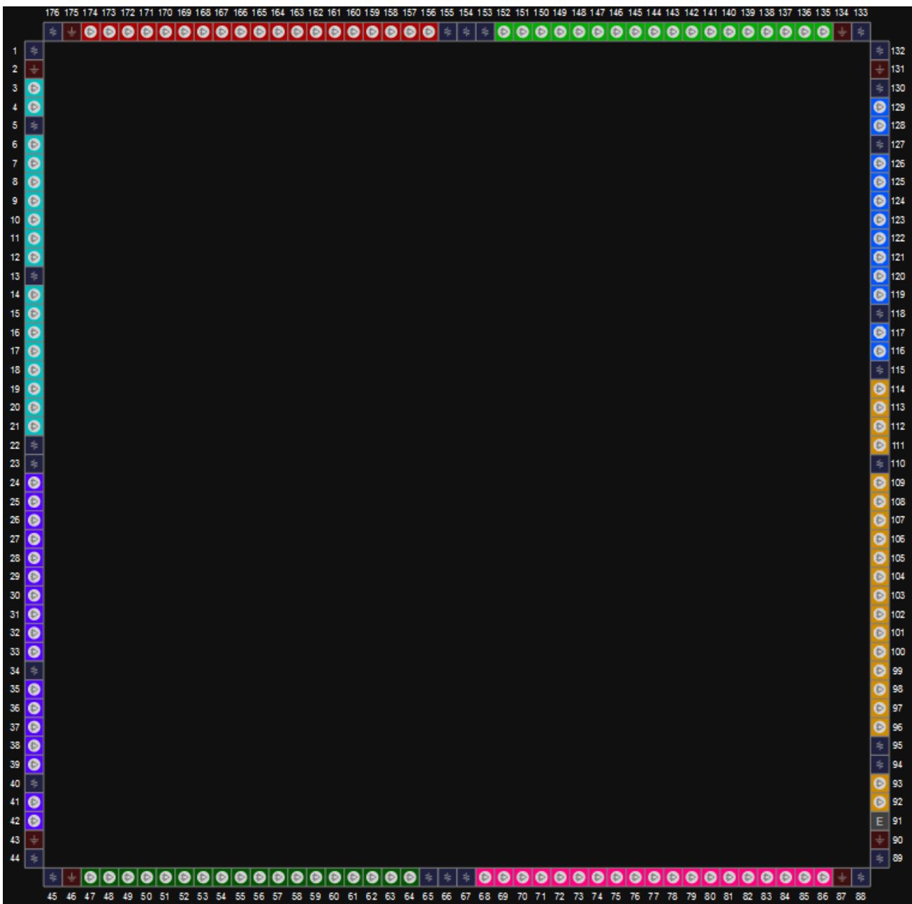
图 3-5 GW2AR-18/GW2AR-18C 器件 LQ176/EQ176 封装管脚分布示意图(内嵌 SDRAM)
