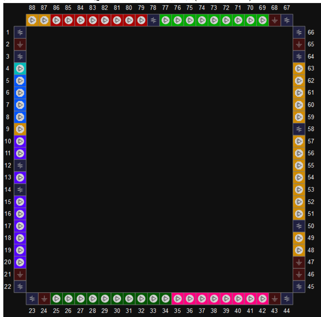
图 3-1 GW2AR-18 器件 QN88 封装管脚分布示意图(内嵌 SDRAM)
