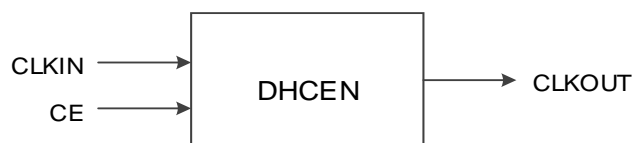
图 4-1 DHCEN 端口示意图
