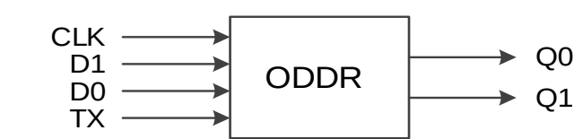
图 4-18 ODDR 端口示意图
