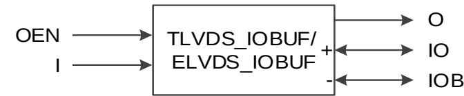
图 3-14 TLVDS_IOBUF/ELVDS_IOBUF 端口示意图
