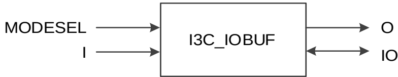
图 3-18 I3C_IOBUF 端口示意图
