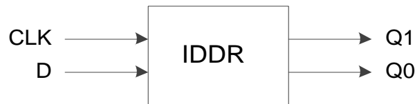
图 4-5 IDDR 端口示意图
