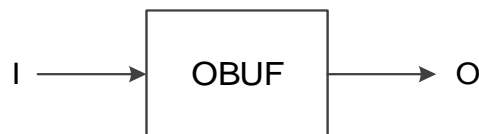
图 3-8 OBUF 端口示意图
