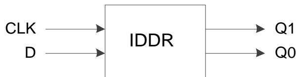
图 4-5 IDDR 端口示意图
