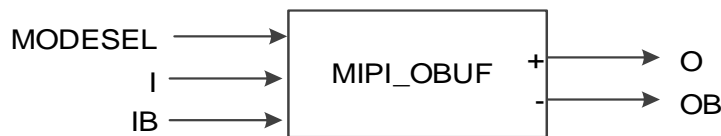
图 3-14 MIPI_OBUF 端口示意图
