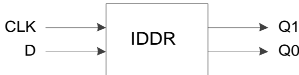
图 4-5 IDDR 端口示意图
