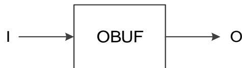
图 3-6 OBUF 端口示意图
