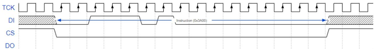
像上述两个指令，0x1500 和 0x3A 指令的时序基本一致，指令都是在 CS 低电平后开始，并在指令传输完成后拉高 CS，遵循这种时序的指令有 0x3C00 (Reconfig/Reprogram)、0x1500 (Write Enable)、0x3A000 (Write Disable)、0x1600 (Program SPI Flash)、0x1200 (Init Address)、0x0500 (Erase SRAM)。
