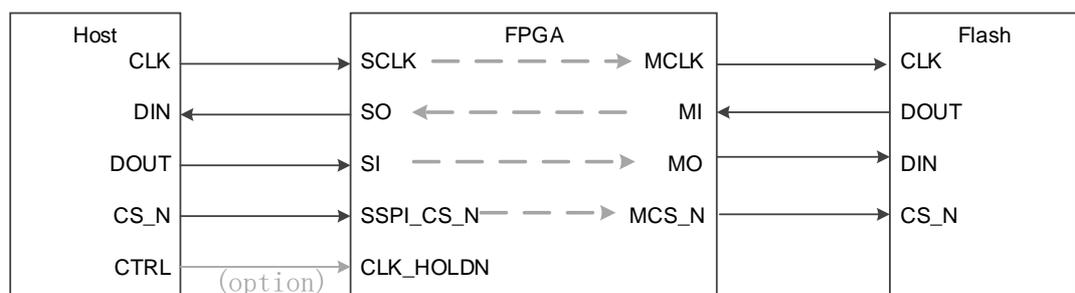
图 5-37 SSPI 配置 Flash 流程图
