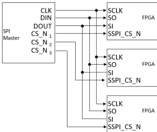
图 5-39 多 FPGA 连线示意图 2
