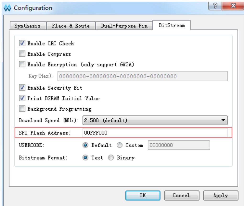
2. 在 Programmer 软件中选择编程外部 Flash，并设置 BitStream 的起始编程地址，此处的编程地址应与 1 步骤中设置的启动地址相同，如图 5-43 所示；
