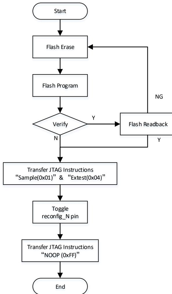
图 5-23 Transfer JTAG Instruction Sample &amp; Exttest 流程图
