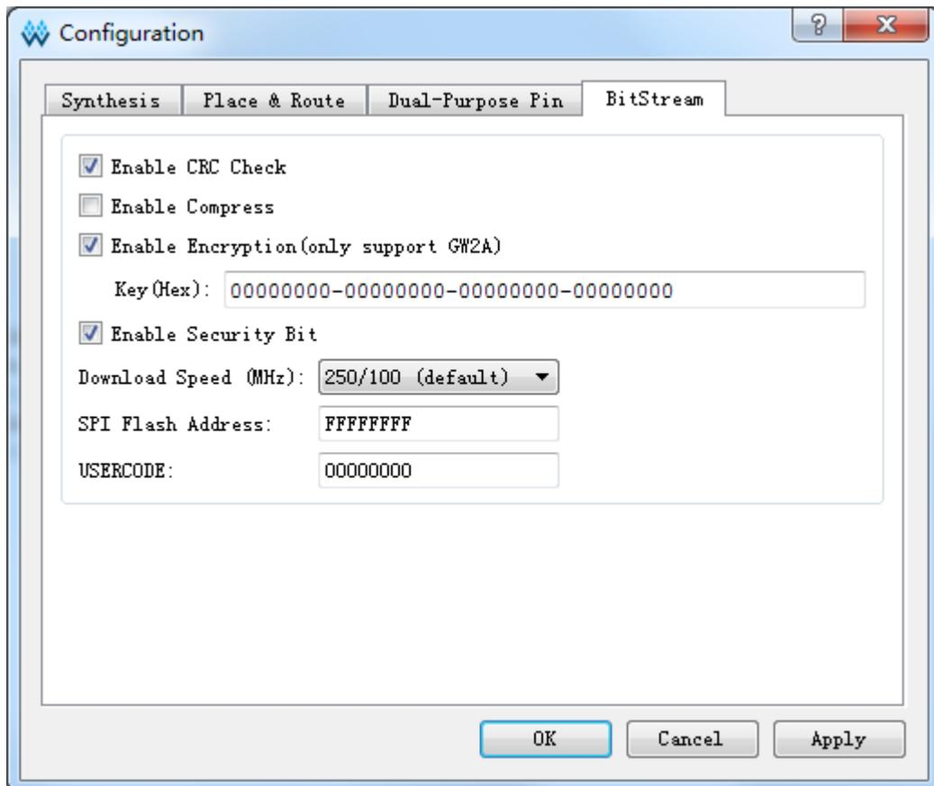
加密密钥设置成功后, 还需要将解密的密钥写入到 FPGA 的密钥存储区, 器件才能解析加密的比特流数据完成配置。
