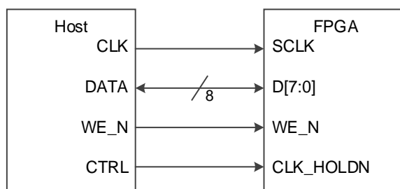
图 6-51 CPU 配置模式连接示意图
