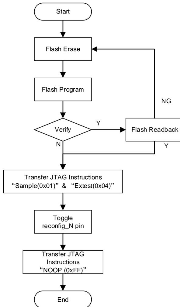
Transfer JTAG Instructions Sample & Extest 流程图如图 6-25 所示。
