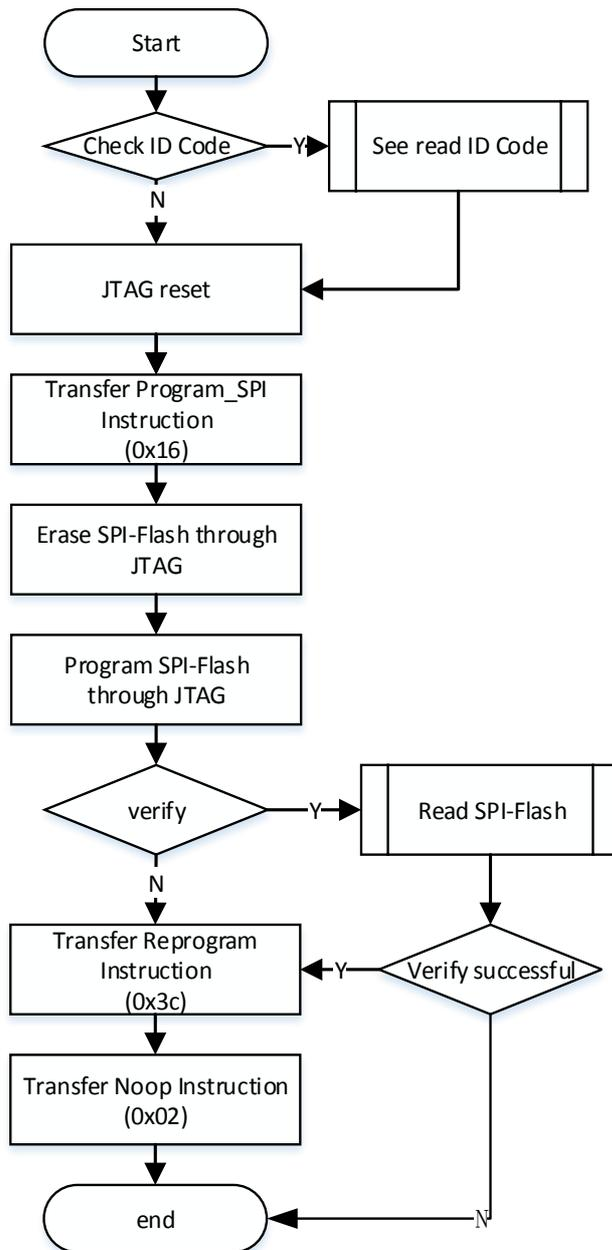
SPI-Flash 擦除流程图如图 6-29 所示:
