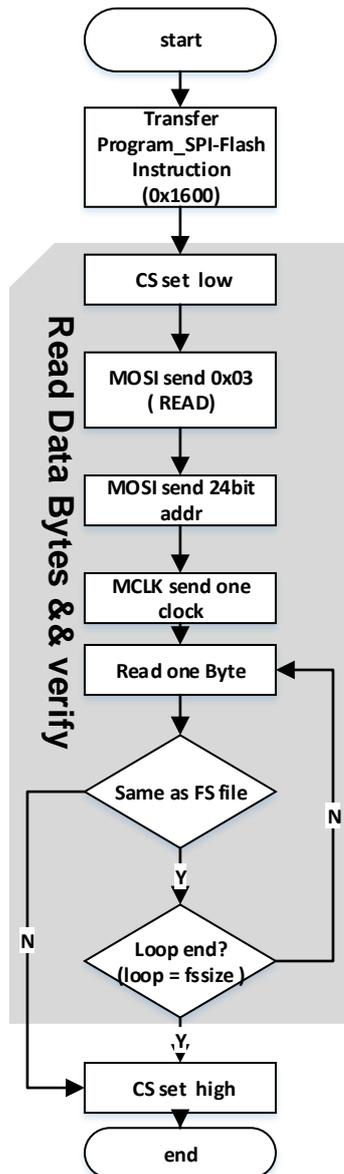
SPI-Flash 回读并校验数据流文件流程：
