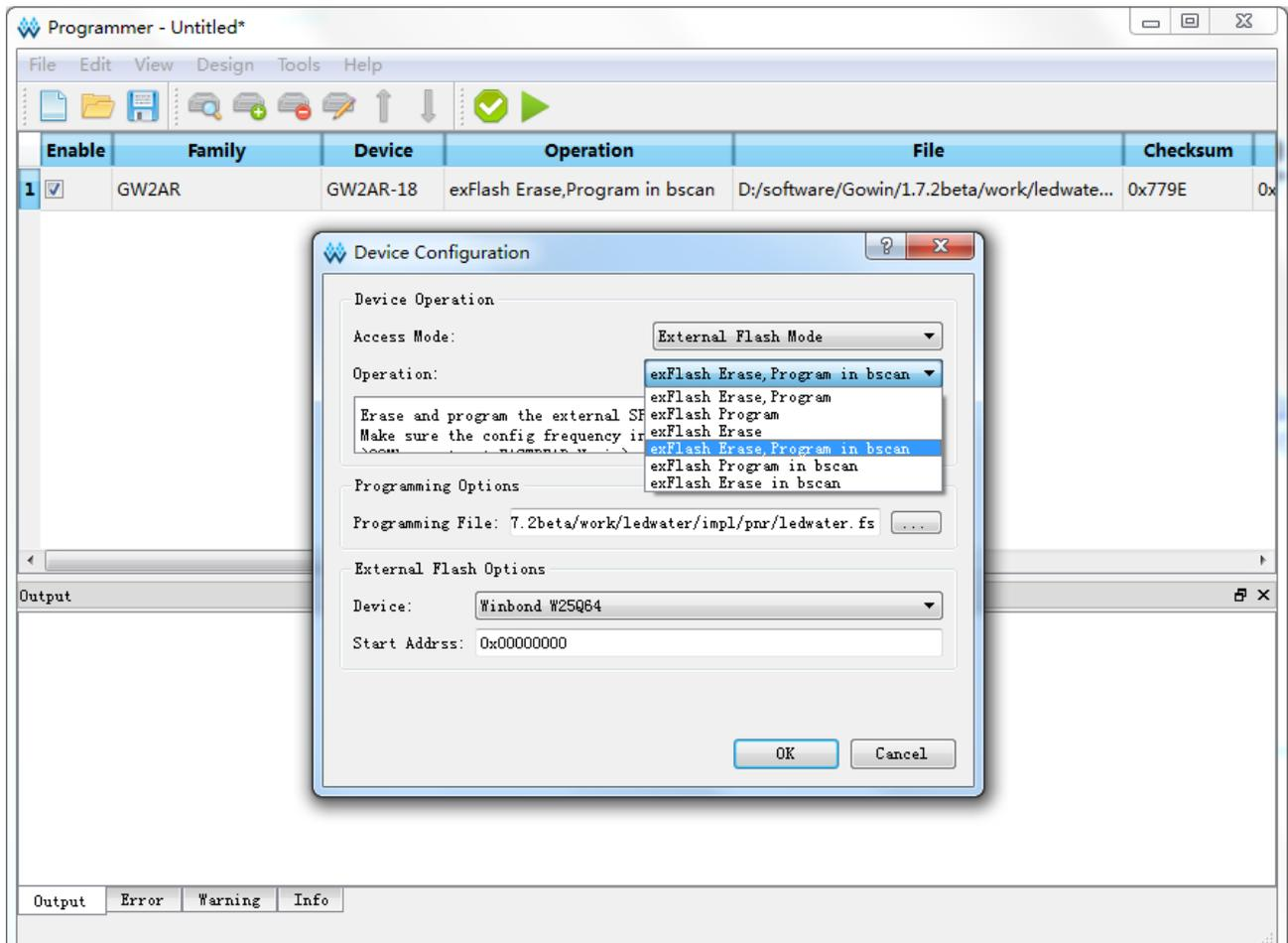
边界扫描操作只能对 FPGA 外部 Flash 进行操作，无法对内置 Flash 或 SRAM 进行编程配置。边界扫描操作编程外部 Flash 时不必关心 FPGA MODE 值的设置，但是相比于常规 JTAG 编程外部 Flash 的方法，边界扫描操作的编程速度较慢。
