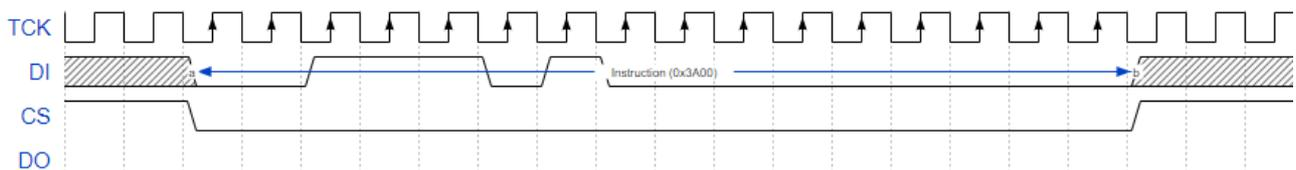
像上述两个指令，0x1500 和 0x3A00 指令的时序基本一致，指令都是在 CS 低电平后开始，并在指令传输完成后拉高 CS，遵循这种时序的指令有 0x3C00 (Reconfig/Reprogram)、0x1500 (Write Enable)、0x3A000 (Write Disable)、0x1600 (Program SPI Flash)、0x1200 (Init Address)、0x0500 (Erase SRAM)。
