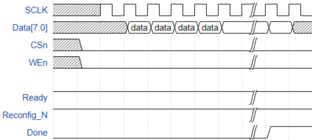
图 6-61 CPU 配置模式时序图
