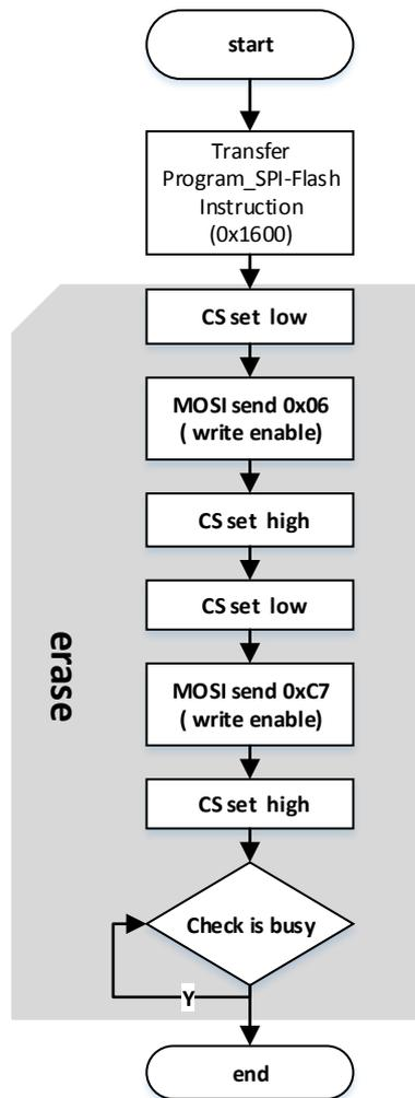
SPI-Flash 擦除流程:
