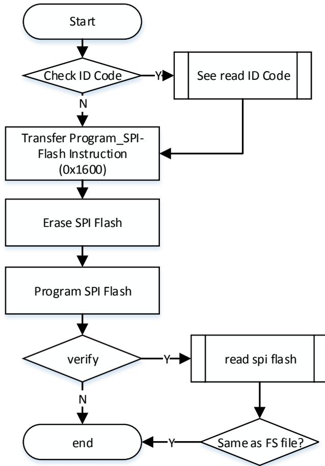
SPI-Flash 擦除流程图如图 6-45 所示:
