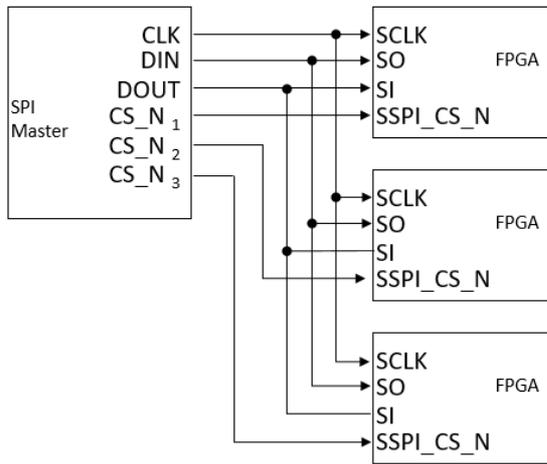
图 6-49 多 FPGA 连线示意图 2
