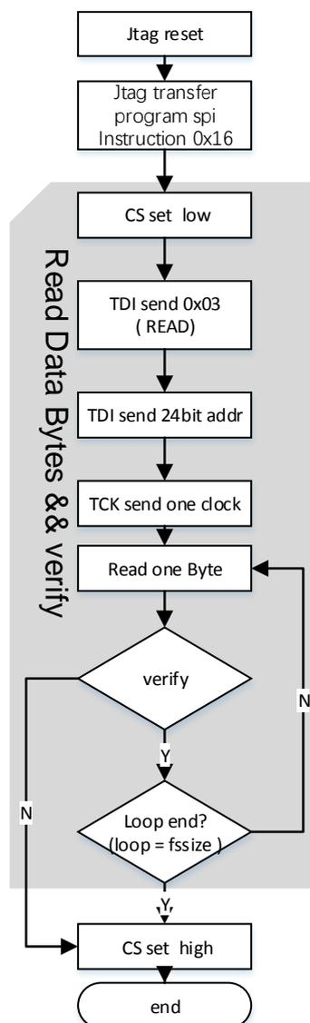
SPI-Flash 回读并校验数据流文件流程：
