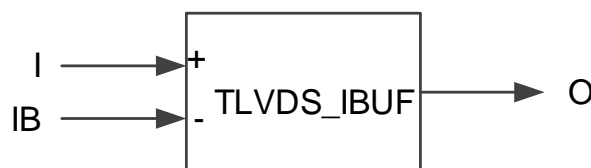
图 3-9 TLVDS_IBUF 端口示意图
