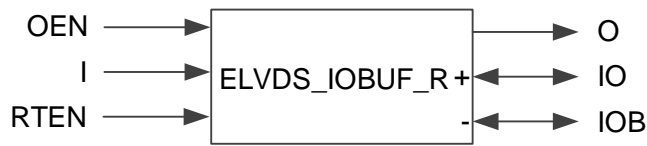
图 3-18 ELVDS_IOBUF_R 端口示意图
