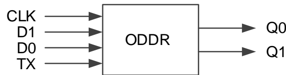
图 4-27 ODDR 端口示意图
