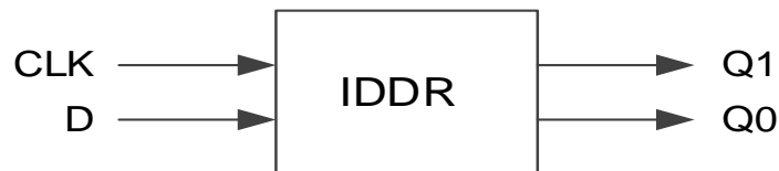
图 4-11 IDDR 端口示意图
