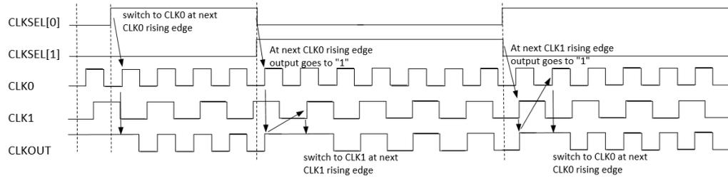
图 3-6 DCS mode: FALLING 时序图
