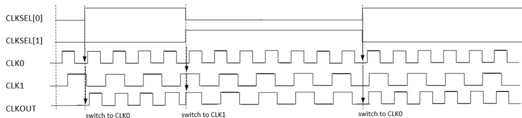
Glitchless 模式时序如图 3-5、图 3-6、图 3-7 和图 3-8 所示，用
