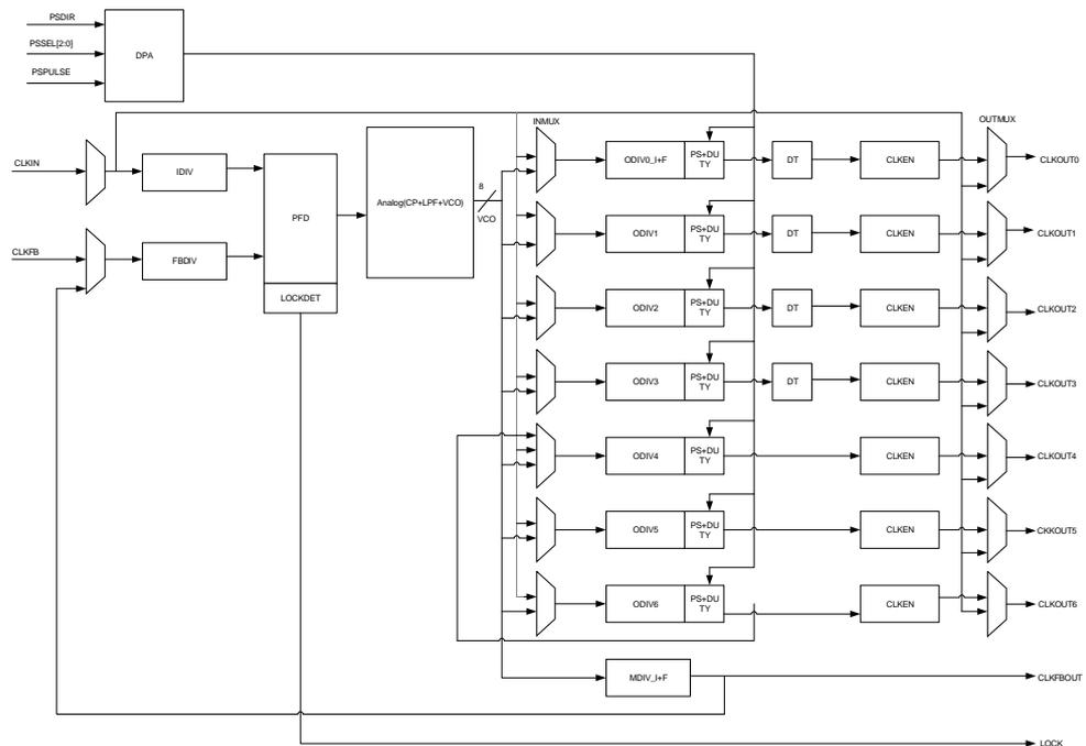
PLL 可基于给定的参考输入时钟进行时钟频率调整、相位调整、占空比调整来产生不同频率、相位和占空比的输出时钟。CLKOUT0 和 CLKFBOUT 支持 1/8 小数频率调整，CLKOUT0~CLKOUT3 支持动静态微调占空比。同时 PLL 支持 CLKOUT6 到 CLKOUT4 的内部级联，支持 SSC 功能，支持时钟去歪斜以实现 CLKIN 和 CLKOUT 的对齐。
