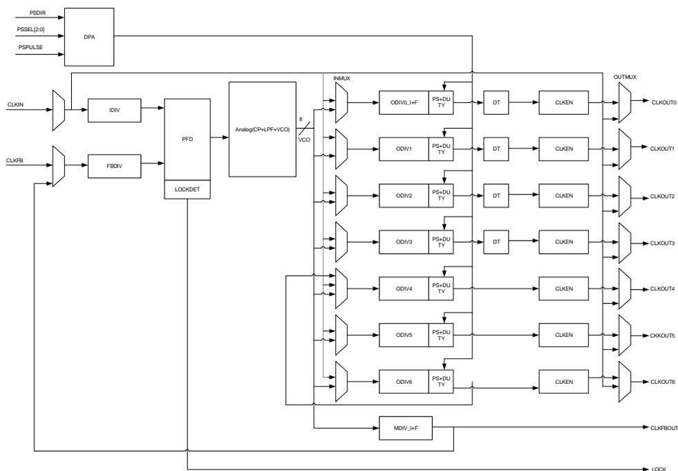
PLLA 可基于给定的参考输入时钟进行时钟频率调整、相位调整、占空比调整来产生不同频率、相位和占空比的输出时钟。CLKOUT0 和 CLKFBOUT 支持 1/8 小数频率调整，CLKOUT0~CLKOUT3 支持动静态微调占空比。同时 PLLA 支持 CLKOUT6 到 CLKOUT4 的内部级联，支持 SSC 功能，支持时钟去歪斜以实现 CLKIN 和 CLKOUT 的对齐。
