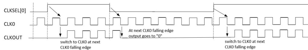
图 3-8 DCS mode: CLK0\_VCC 时序图
