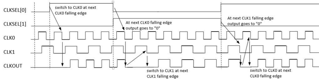
图 3-7 DCS mode: CLK0\_GND 时序图
