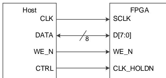
图 5-29 CPU 配置模式连接示意图
