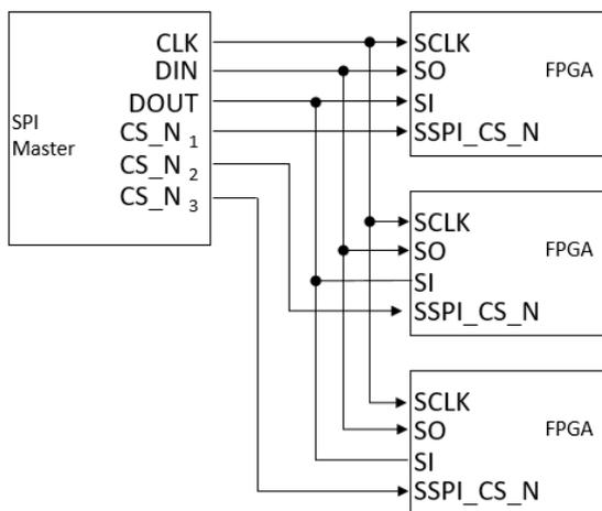
图 5-26 多 FPGA 连线示意图 2
