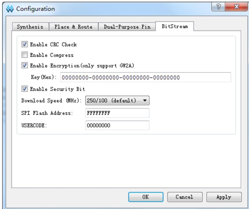
加密密钥设置成功后, 还需要将解密的密钥写入到 FPGA 的密钥存储区, 器件才能解析加密的比特流数据完成配置。
