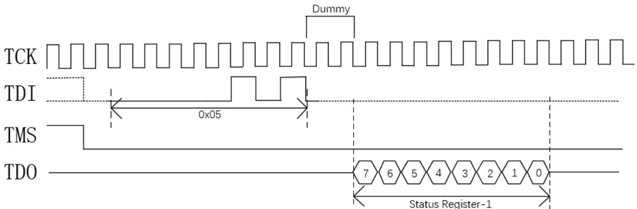
Read Status Register-1 指令用于读取一个 8bit 状态寄存器, 在 TMS 为低电平并在一个时钟周期 (TCK) 后, 将指令“0x05”在 TCK 上升沿时候移入数据输入 (TDI) 引脚, 再经历 2 个 dummy clock 后, Status Register-1
