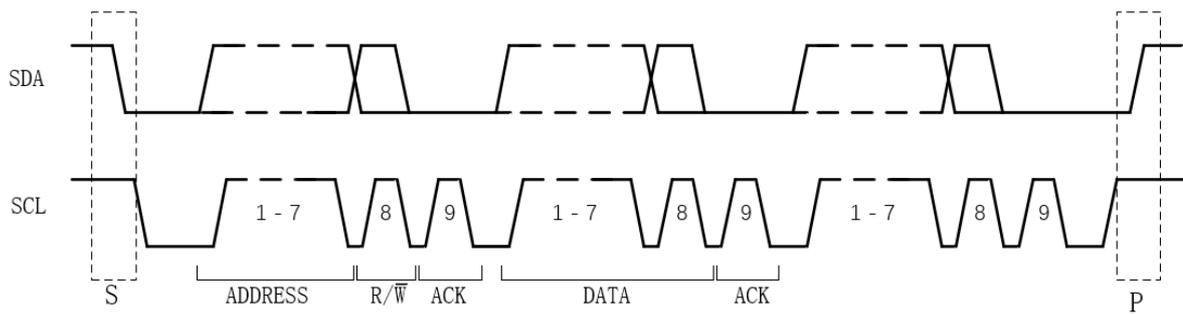
I<sup>2</sup>C 是串行传输总线，按照上图所示协议进行数据传输，正常状态下，SDA 和 SCL 都处于高电平。
