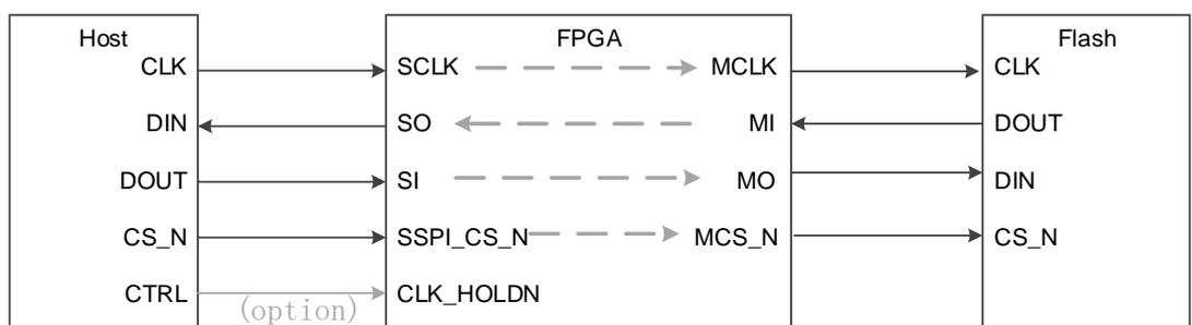
烧录流程示意图见图 5-24。首先通过 SSPI 向 FPGA 发送指令“Program SPI Flash”（0x1600）指令，完成后 FPGA 可以转发 SSPI 到 Flash，Host 端的 SSPI 可以直接访问 Flash，接下来就可以按照 Flash 的相关时序对其进行编程。
