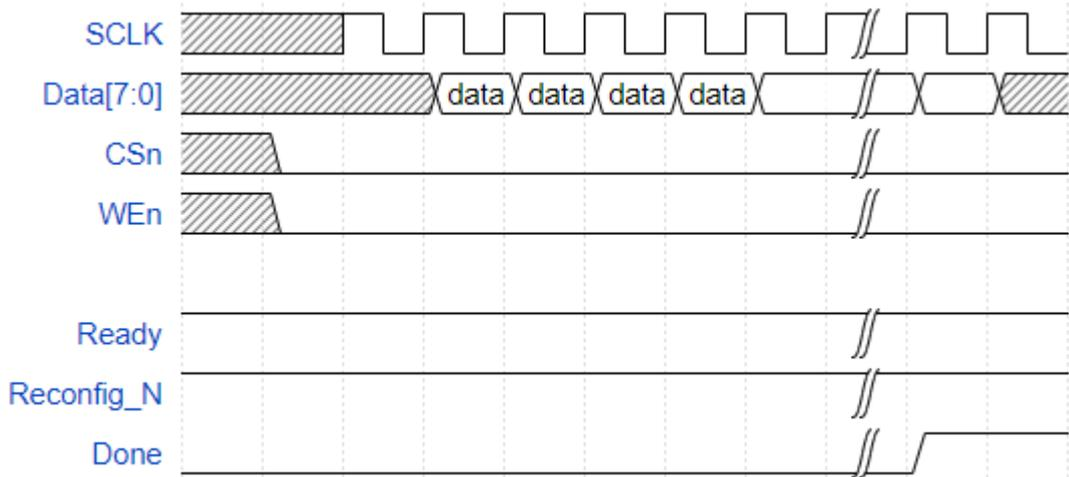
图 5-35 CPU 配置模式时序图
