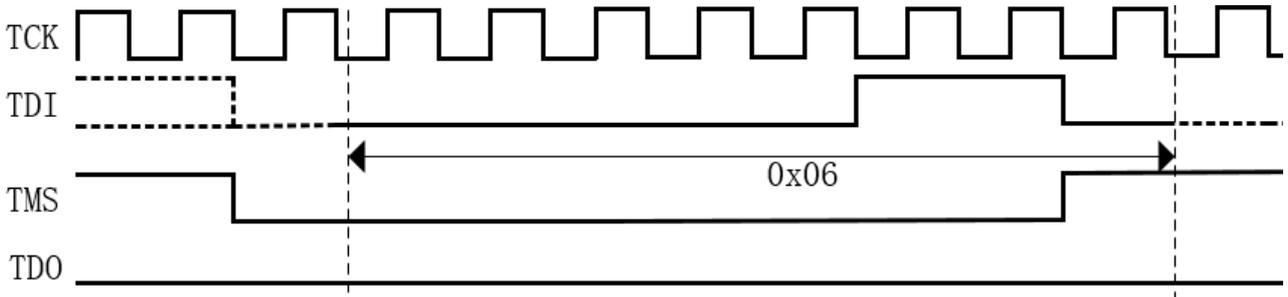
WriteEnable 指令(上图)用来设置 Flash Status Register 的 Write Enable Latch (WEL) 位, WEL 位必须在每次 Page-Program、Sector Erase、Chip Erase 前设置。在 TMS 为低电平并在一个时钟周期(TCK)后,将指令“0x06”移入数据输入 (TDI) 引脚上, 0x06 的最后一个 bit 位“0”跟随 TMS 在同一个时钟周期内完成。
