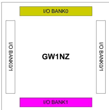
封装与管脚手册列举了 GW1NZ 系列 FPGA 产品每种封装的管脚分布示意图。GW1NZ 系列 FPGA 产品的两个 BANK 用两种颜色区分，黄色填充表示 BANK0，紫色填充表示 BANK1。
