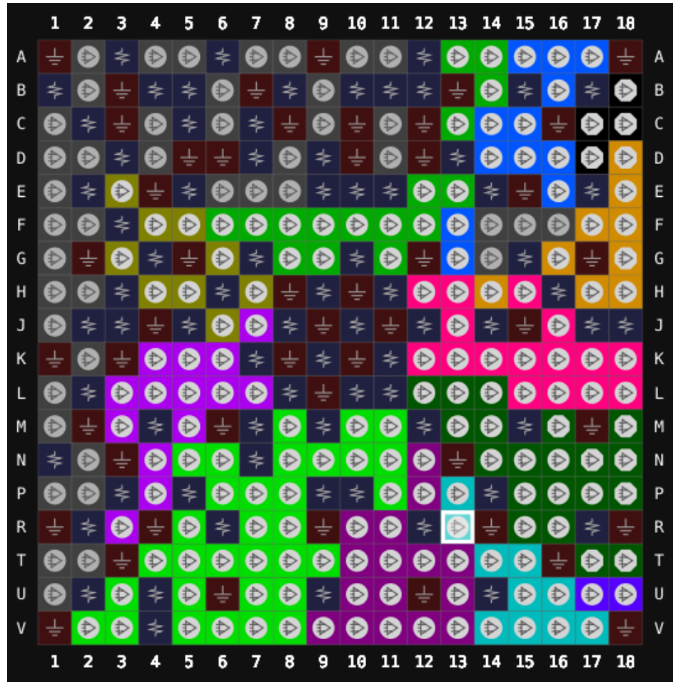
图 3-7 GW5AT-60 器件 UG324 封装管脚分布示意图（顶视图）
