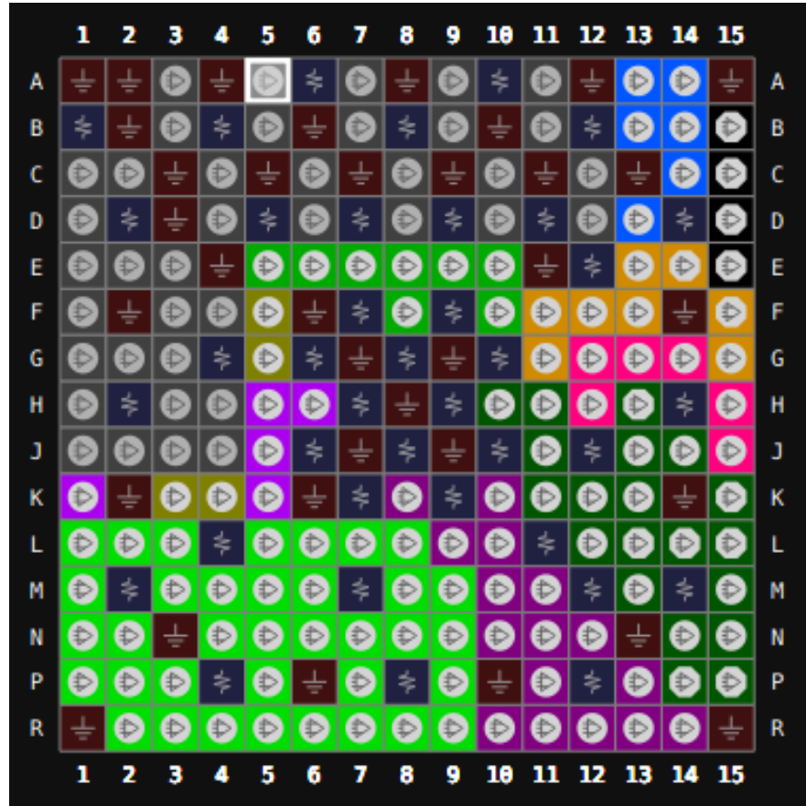
图 3-5 GW5AT-60 器件 UG225 封装管脚分布示意图（顶视图）
