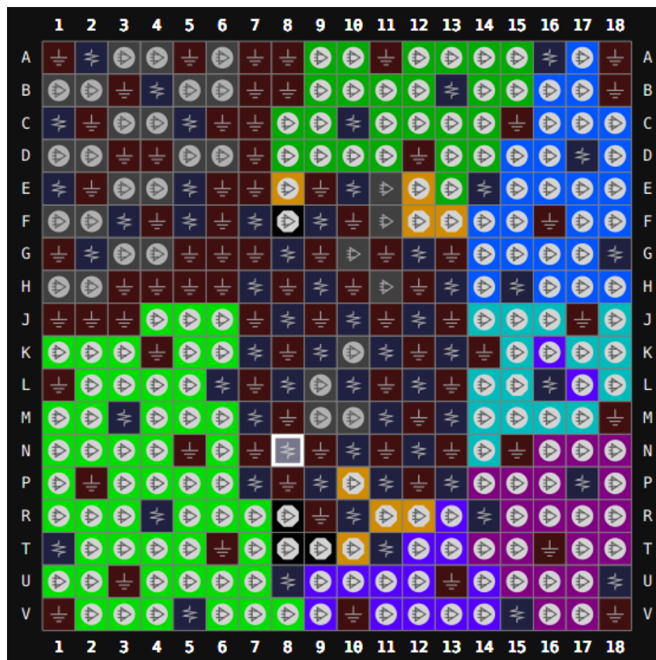
图 3-8 GW5AT-60 器件 UG324A 封装管脚分布示意图（顶视图）
