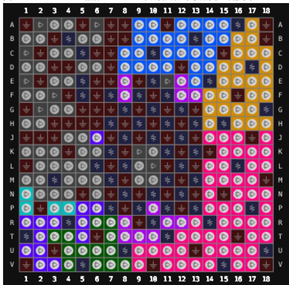
图 3-16 GW5AT-138 器件 UG324A 封装管脚分布示意图（顶视图）
