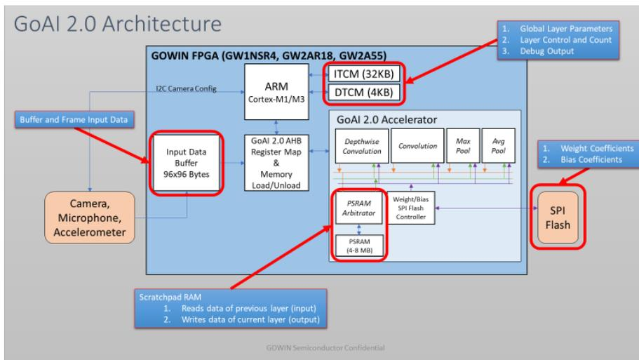
GoAI 2.0 平台结构使其支持的层深尽可能大、卷积和池化层数尽可能多，因为 GW1NSR-4C 中集成了 PSRAM，可以用来存储层相关参数。GW1NSR-4C 包含 8MB 的 PSRAM，其中 4MB 为输入层缓冲，另外 4MB 为输出层缓冲。这意味着一个层输入和层输出的大小最大可达 4MB。Cortex-M3 硬核处理器内的 ITCM 嵌入式闪存大小为 32KB，其只需存储每层的控制环路和滤波器参数。外部 SPI 闪存则存储每层的权重和偏置系数，并可根据所需模型大小进行调整。
