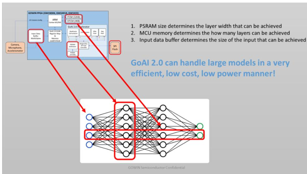
使用 Mobilenet v1.025 和 COCO 数据集对 GoAI 2.0 平台进行测试。Mobilenet 是一个具有 28 层的相当大的卷积神经网络。使用 GoAI 2.0，该模型的推理延迟仅为 162 毫秒。
