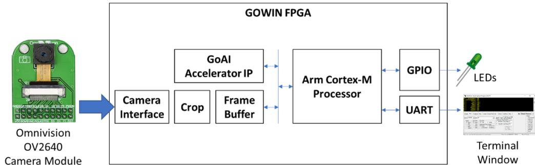
对 Arm Cortex-M3 处理器和加速器进行进一步的分析显示单独使用 Arm Cortex-M3 处理器与使用 GoAI 加速器相比，使用 GoAI 加速器性能提高了约 78 倍。
