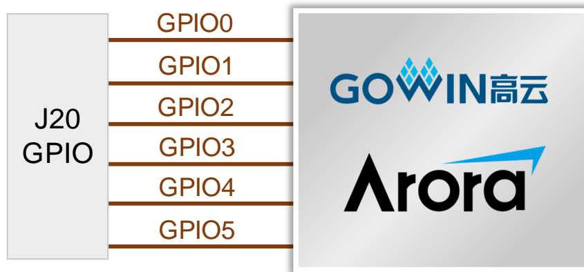
图 3-12 GPIO 连接示意图
