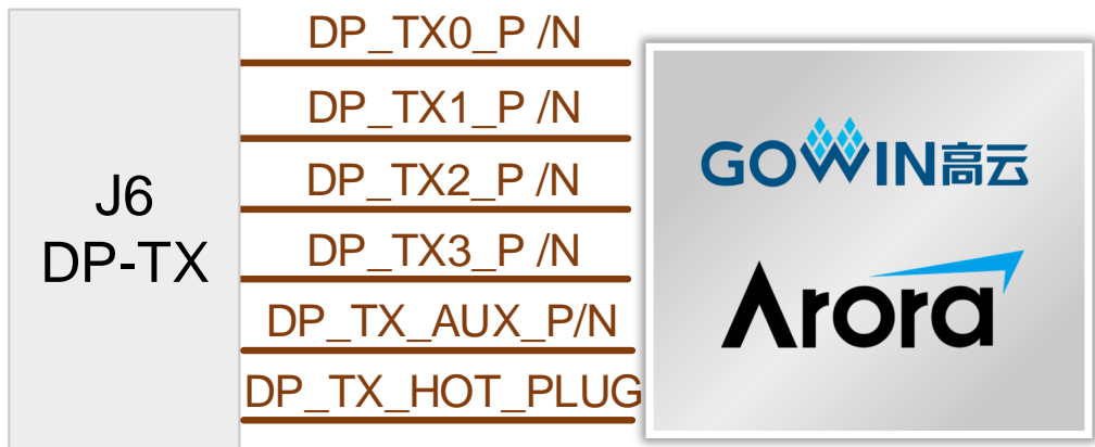
图 3-5 DP-TX 接口连接示意图
