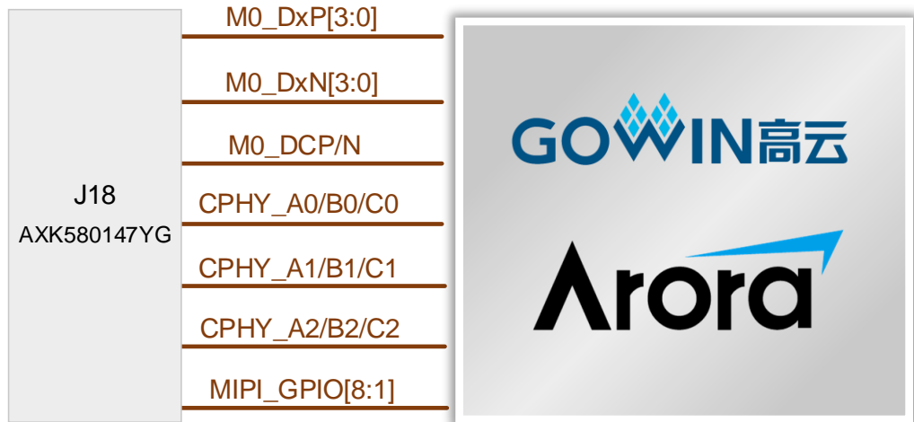
图 3-8 MIPI DPHY 软核接口连接示意图
