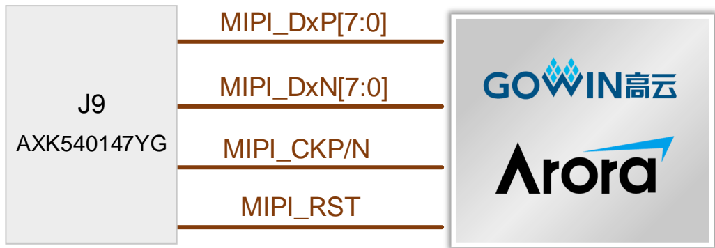
图 3-8 MIPI DPHY 软核接口连接示意图
