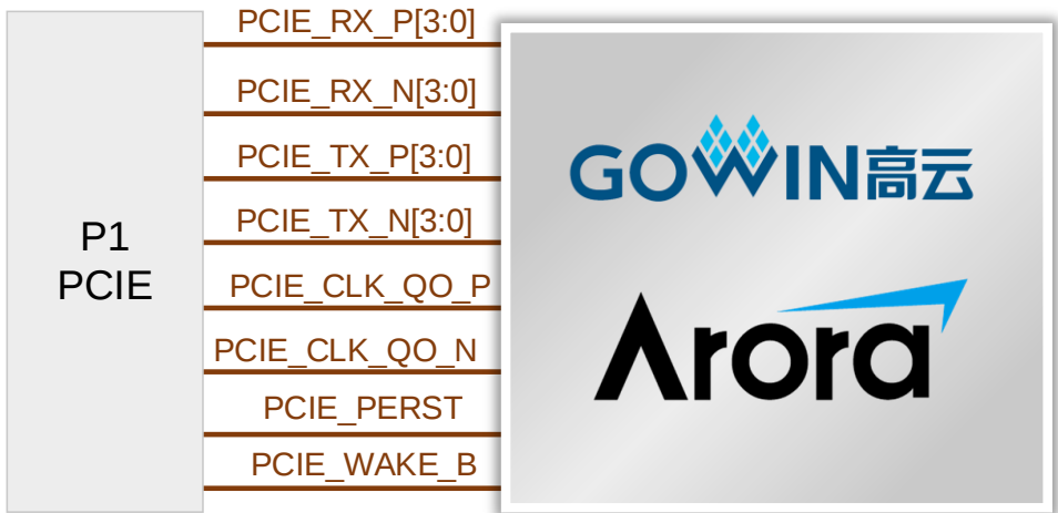
图 3-8 PCIE 接口连接示意图
