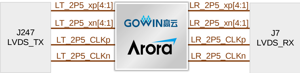
图 3-10 LVDS 接口连接示意图
