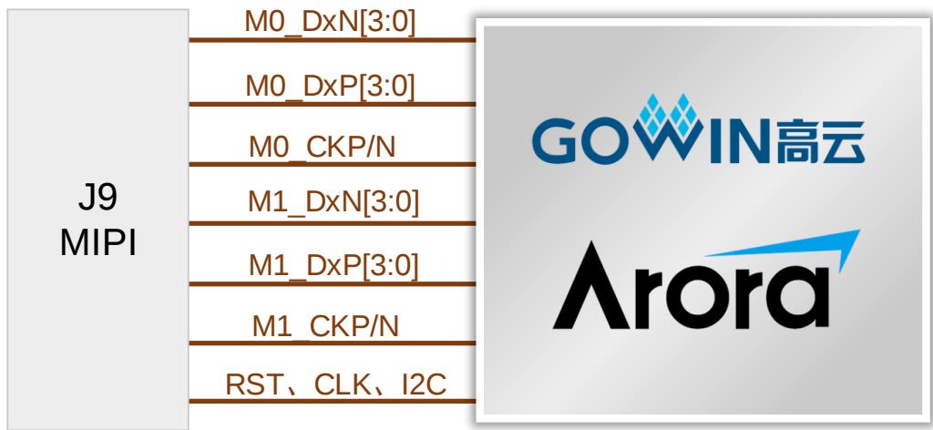
图 3-7 MIPI 接口连接示意图
