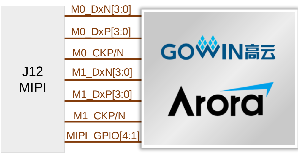
图 3-11 MIPI 接口连接示意图
