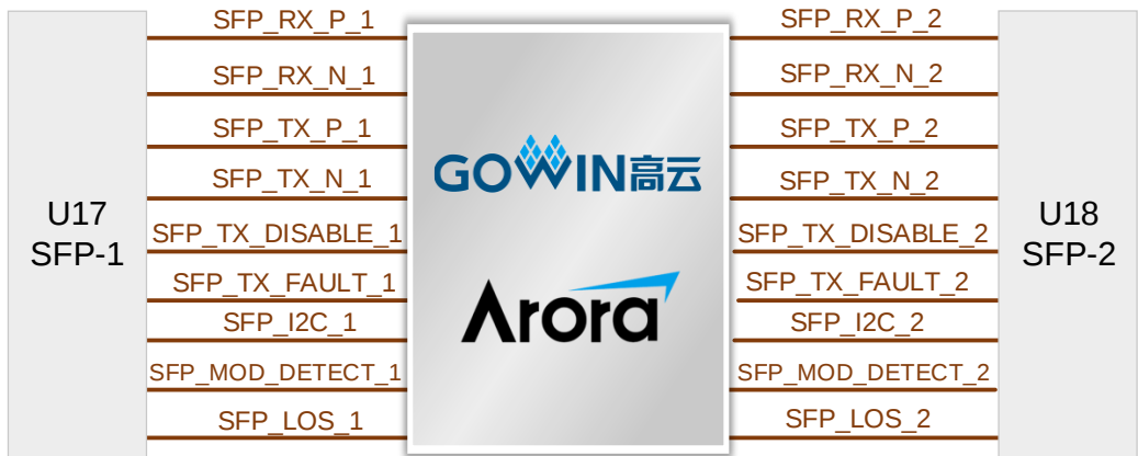
图 3-6 SFP 接口连接示意图
