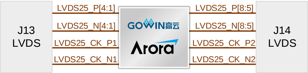
图 3-12 LVDS 接口连接示意图
