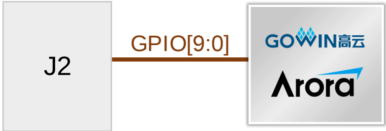
图 3-17 GPIO 接口连接示意图
