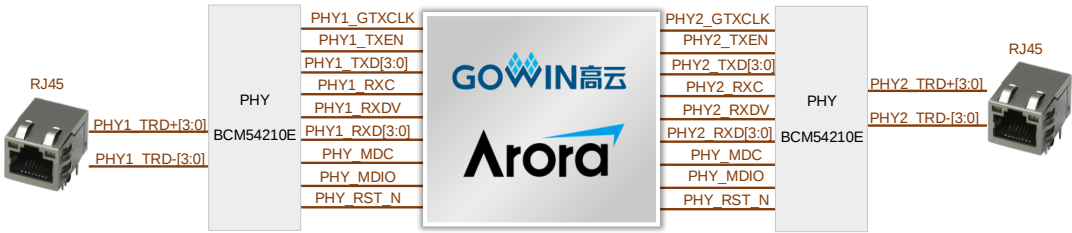
图 3-10 以太网接口连接示意图
