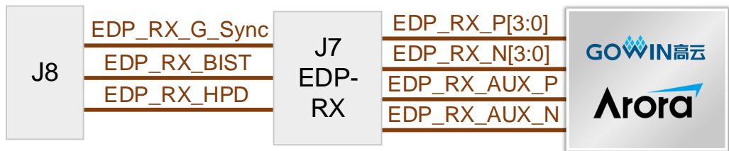
图 3-9 EDP-RX 接口连接示意图
