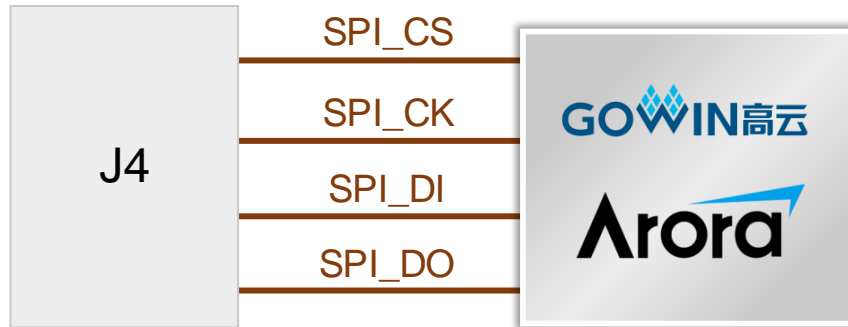
图 3-7 SPI 接口连接示意图
