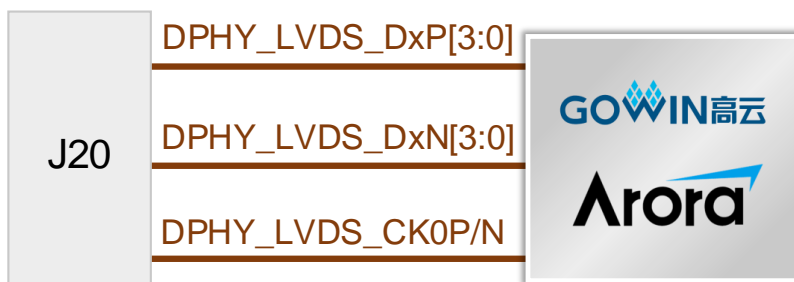
图 3-6 MIPI DPHY 软核/LVDS 接口连接示意图
