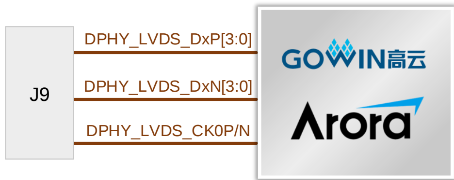
图 3-6 MIPI DPHY 软核/LVDS 接口连接示意图
