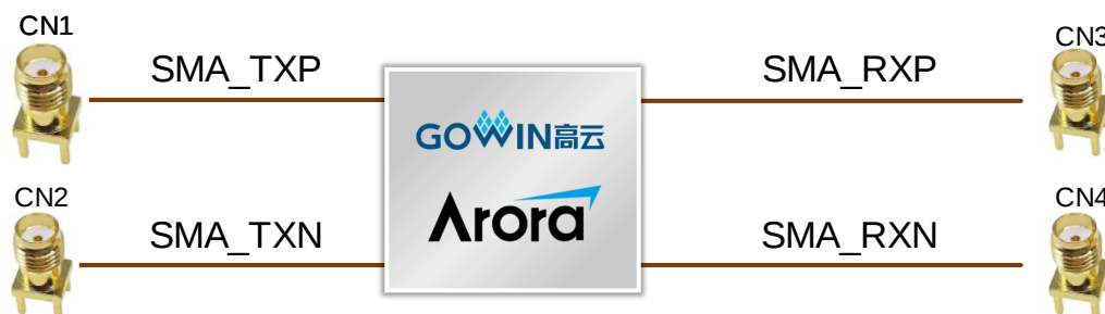
图 3-12 SMA 接口连接示意图
