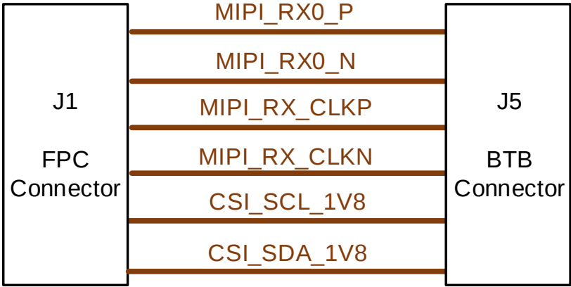
图 4-10 MIPI DPHY 软核接口连接示意图
