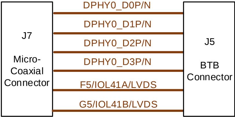
图 4-9 MIPI DPHY 硬核接口连接示意图
