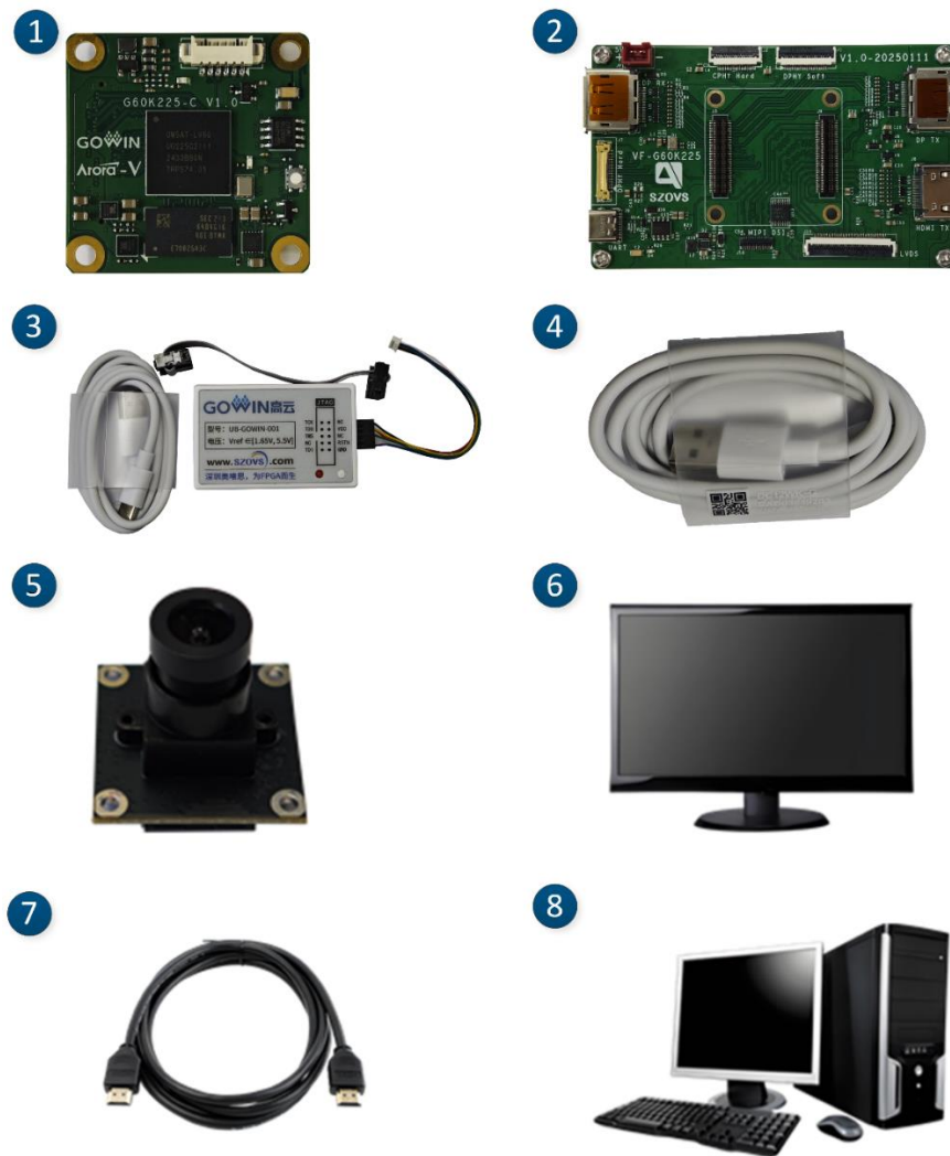
图 4-1 SC130GS 黑白 1 Lane HDMI 屏幕显示工程硬件组成
