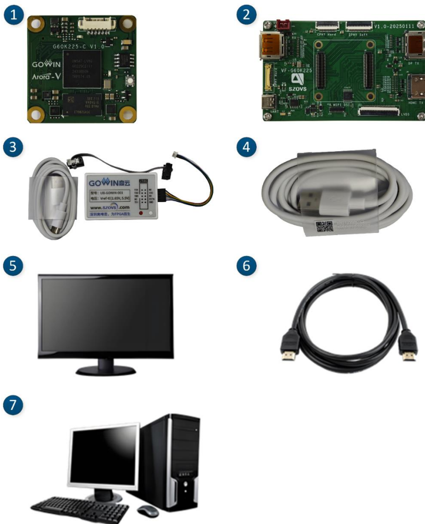
图 3-17 1920*1080@60 的 DDR3 图像缓存及 HDMI 屏幕显示实验硬件组成
