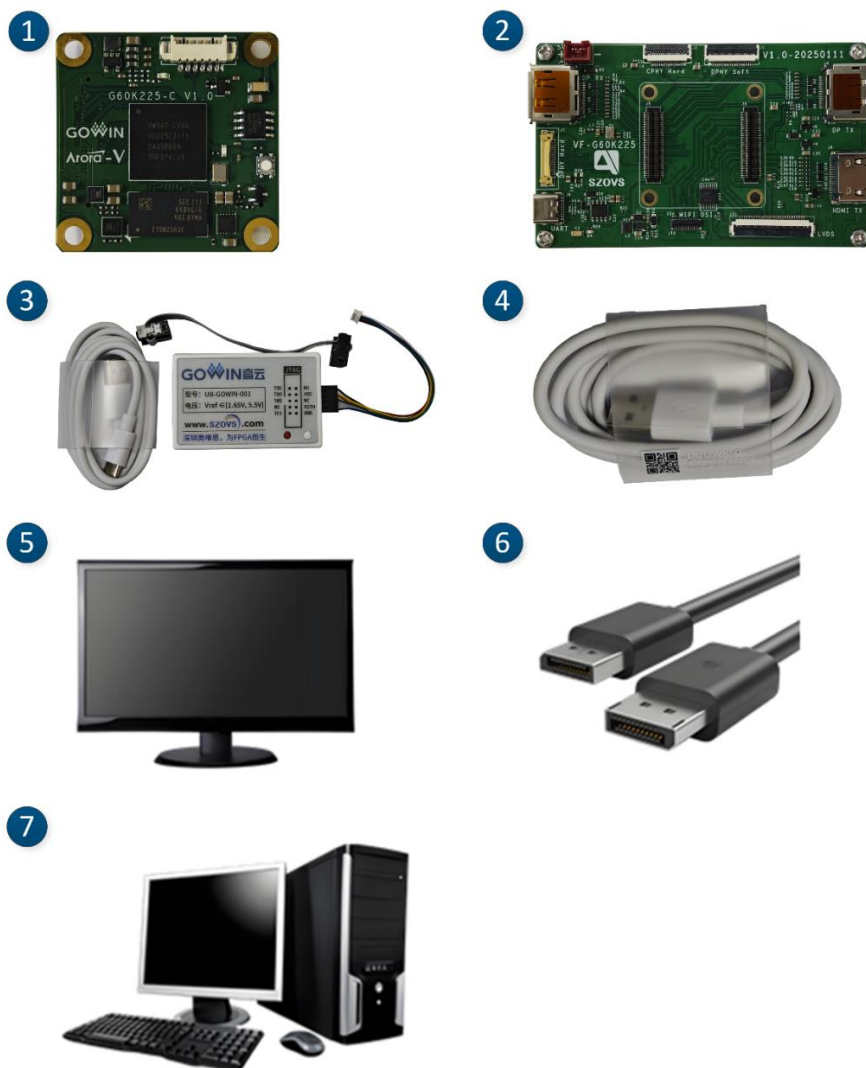
图 3-15 1920*1080@60 DP 屏幕接收显示实验硬件组成
