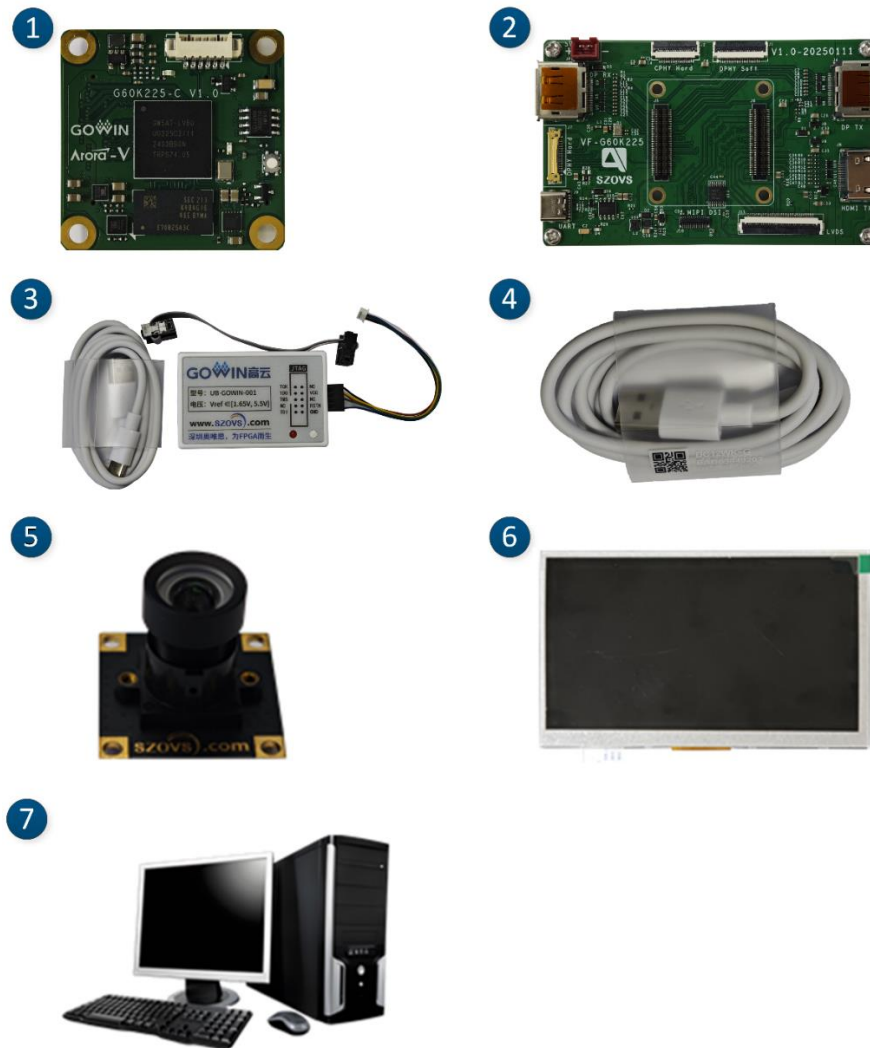
图 4-7 SC2210 彩色 1 Lane LVDS 屏幕显示工程硬件组成
