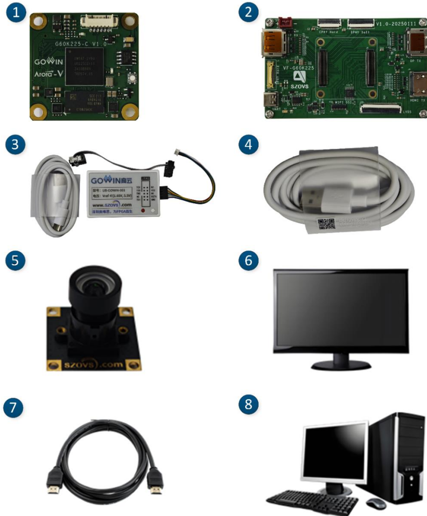
图 4-5 SC2210 彩色 1 Lane HDMI 屏幕显示工程硬件组成
