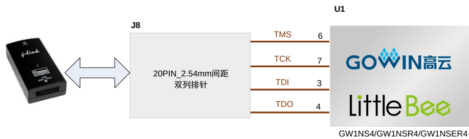
图 3-2 FPGA J-Link 连接示意图
