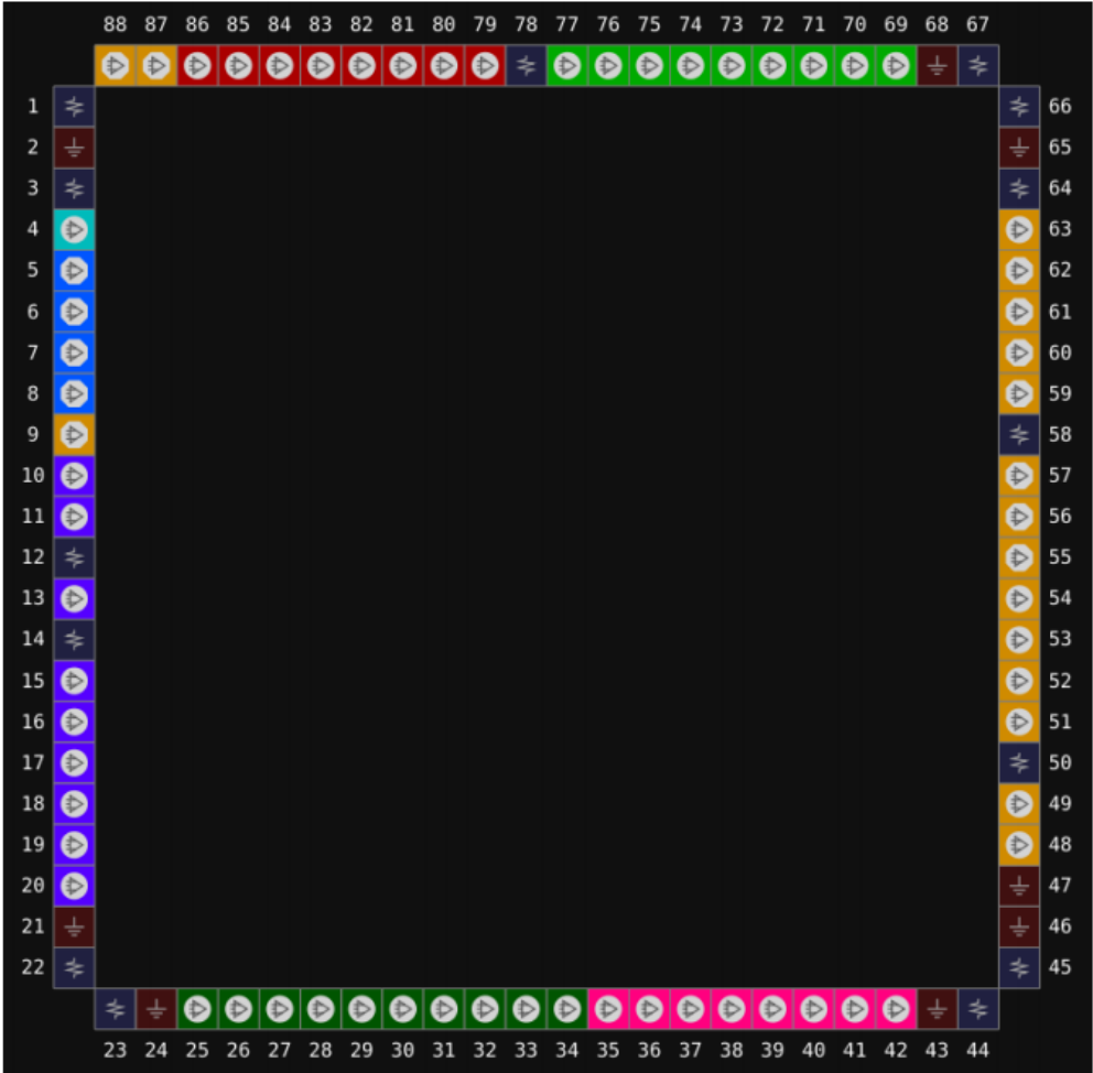
图 3-2 GW2AR-18 器件 QN88P 封装管脚分布示意图（顶视图）
