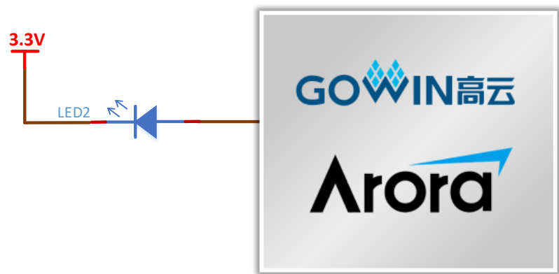
图 3-10 LED 连接示意图
