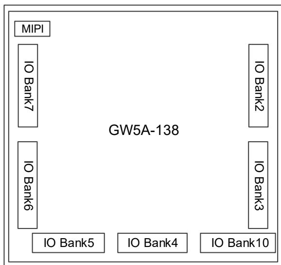
每个 Bank 有独立的 I/O 电源  $V_{CCIO}$ 。 $V_{CCIO}$  可以设置为 3.3V、2.5V、1.8V、1.5V、1.35V、1.2V 或 1V。辅助电压  $V_{CCX}$  供电电压为 1.8V。
