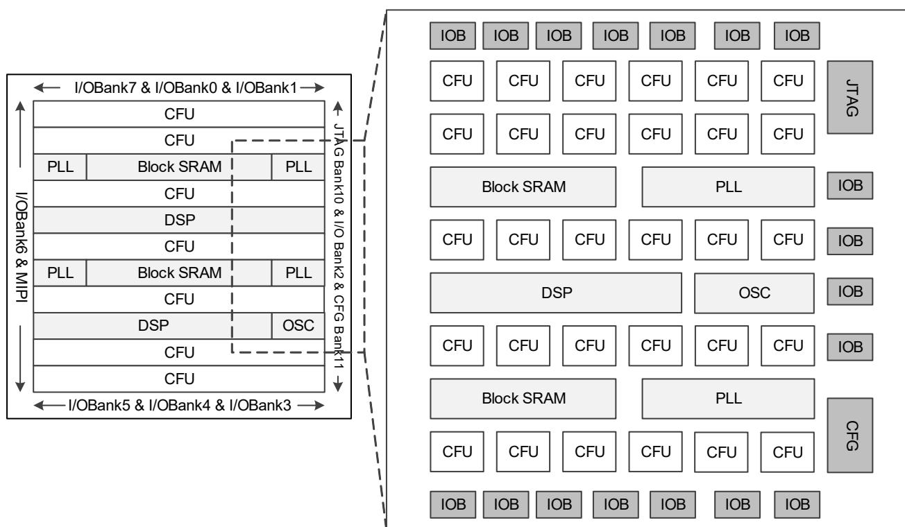
图 2-3 结构概念示意图 (GW5A-60)
