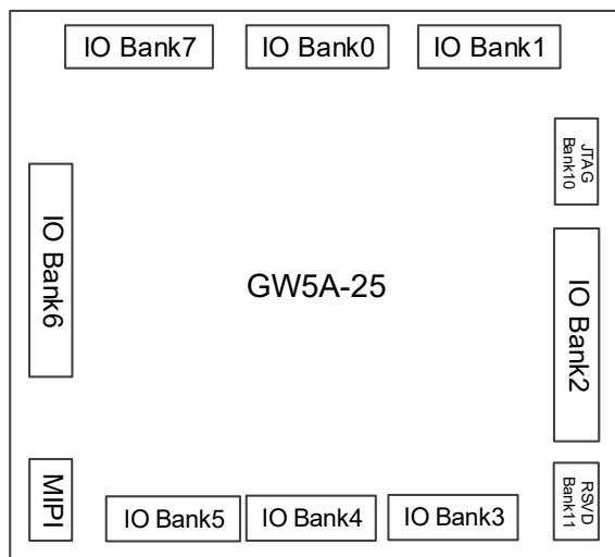
每个 Bank 有独立的 I/O 电源  $V_{CCIO}$ 。 $V_{CCIO}$  可以设置为 3.3V、2.5V、1.8V、1.5V、1.35V 或 1.2V。辅助电压  $V_{CCX}$  供电电压支持 2.5V，3.3V。
