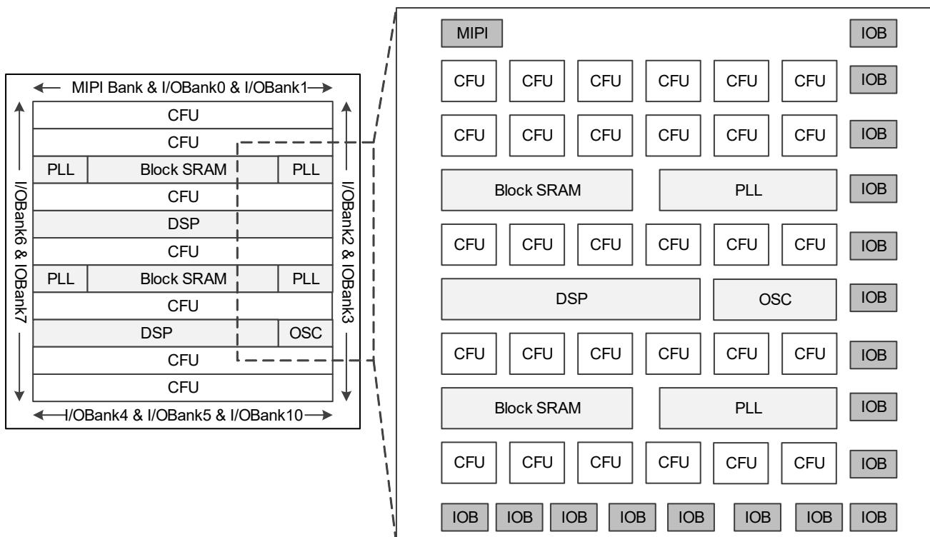
GW5A 系列 FPGA 产品内部是一个逻辑单元阵列，外围是输入输出模块( IOB )，器件内嵌了块状静态随机存储器 (BSRAM) 模块、数字信号处理模块 DSP、MIPI D-PHY、ADC、PLL 资源和片内时钟振荡器。详细资源信息请参考 [1.2 产品信息列表](#)。
