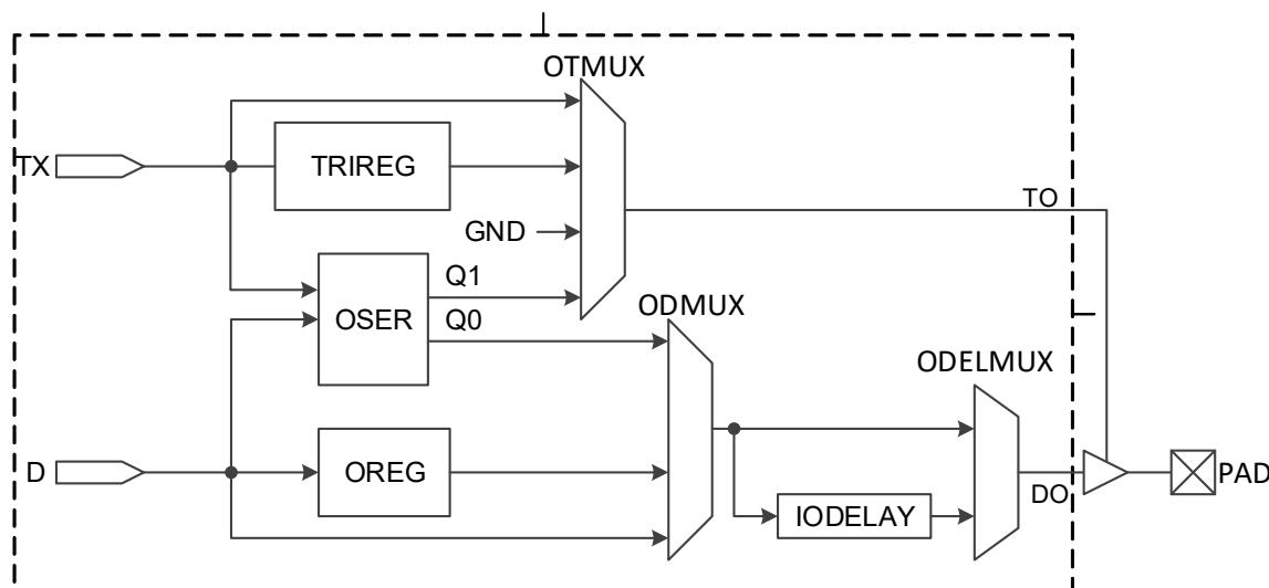
图 2-11 为 GW5A 系列 FPGA 产品的 I/O 逻辑的输入部分。
