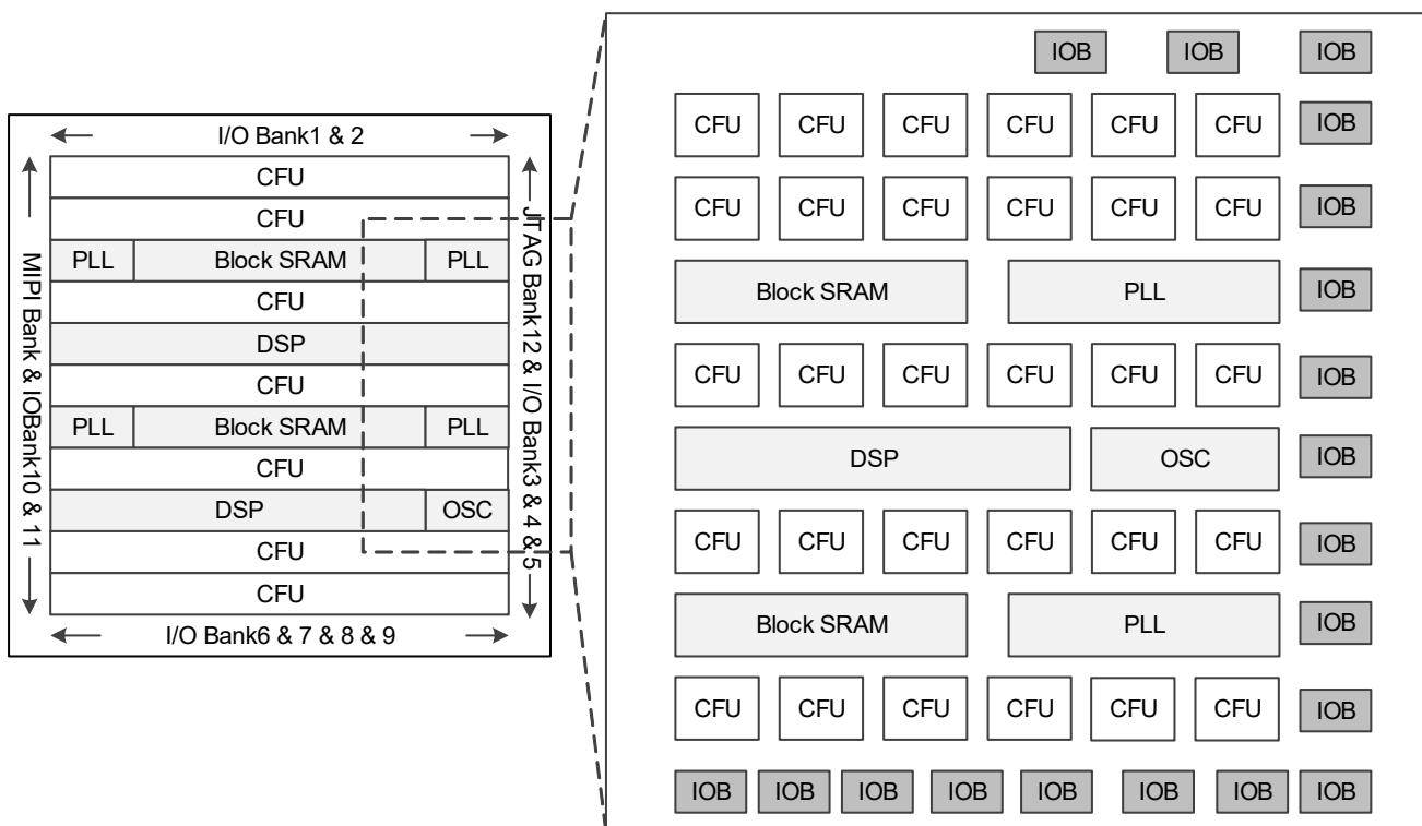
图 2-4 结构概念示意图 (GW5A-138)
