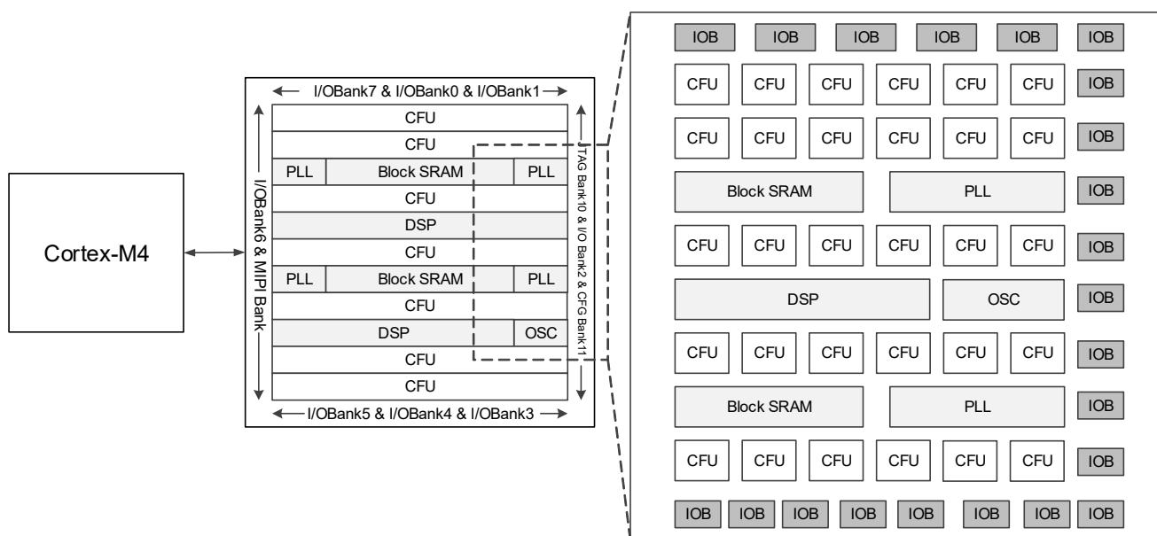
图 2-2 结构概念示意图(GW5AS-138)
