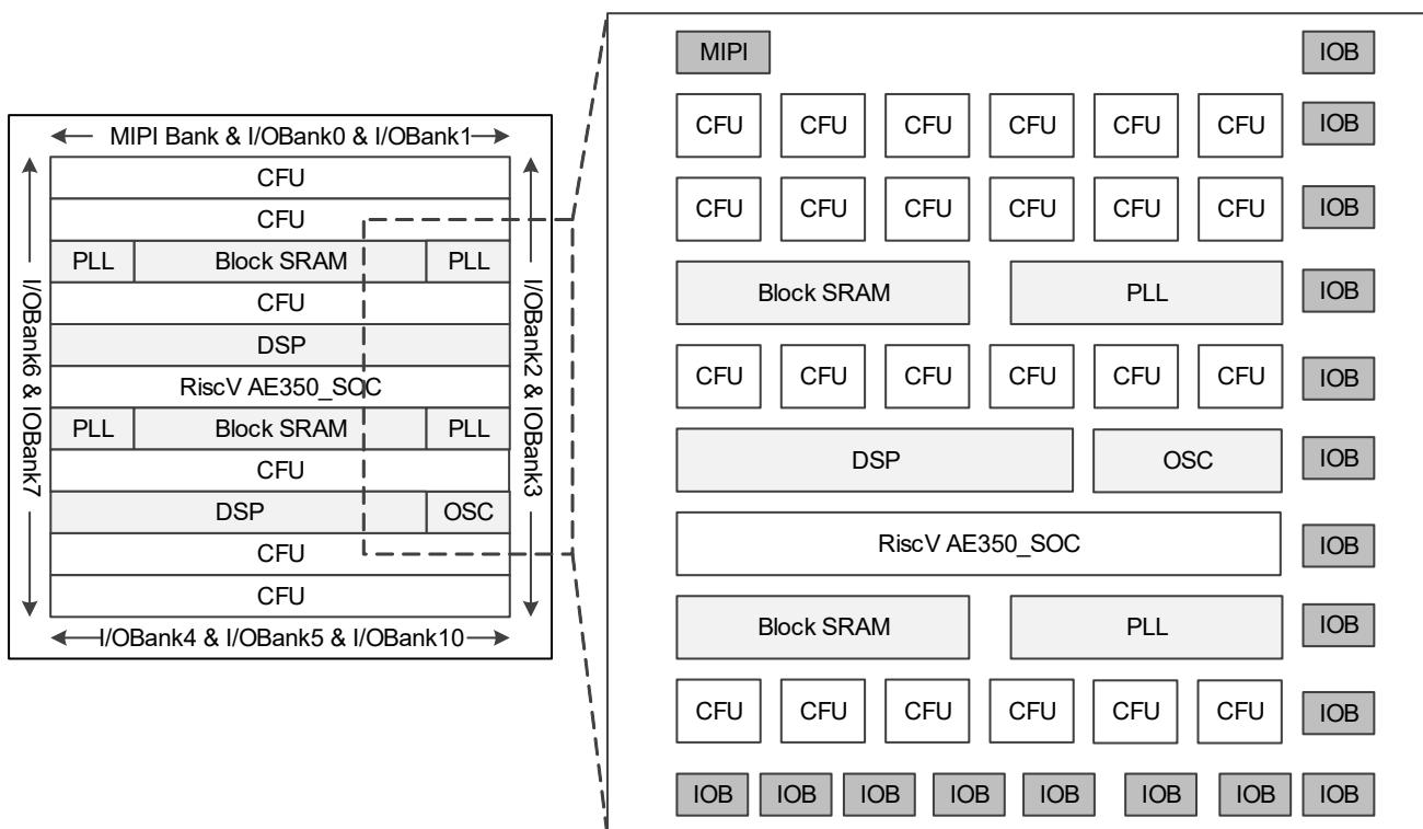
图 2-1 为 GW5AS-25 结构示意图，集成最新一代的嵌入式 ARM®内核处理器 Cortex-M4。详细资料请参考 [2.6 Cortex-M4 系统\(GW5AS-25\)](#)。
