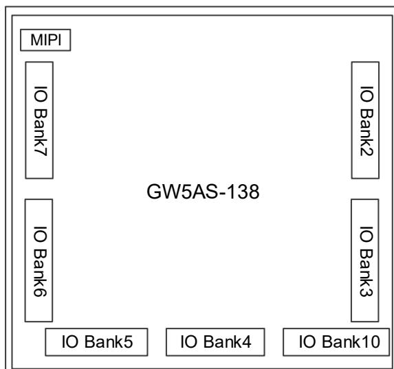
每个 Bank 有独立的 I/O 电源 V<sub>CCIO</sub>。V<sub>CCIO</sub> 可以设置为 3.3V、2.5V、1.8V、1.5V、1.35V、1.2V 或 1V。辅助电压 V<sub>CCX</sub> 供电电压为 1.8V。
