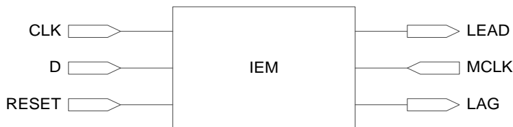
图 2-10 GW1NS 的 IEM 示意图
