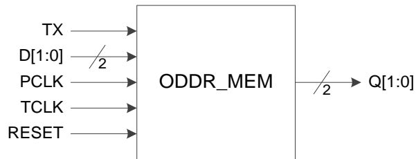
图 3-23 IO 逻辑的 ODDR_MEM 输出示意图
