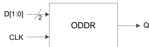
图 3-13 I/O 逻辑的 DDR 输出示意图
