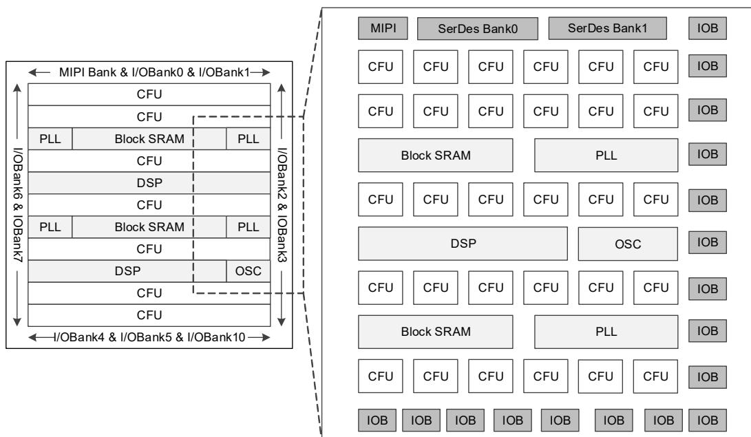
图 2-2 结构概念示意图 (GW5AT-60)
