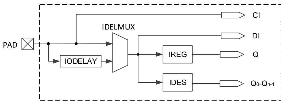
GW5AT 系列 FPGA 产品的 I/O 逻辑的组成模块说明如下：
