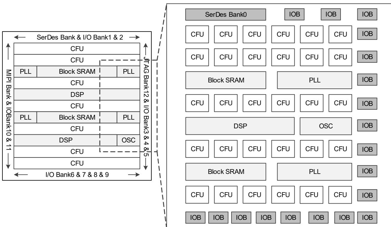
图 2-3 结构概念示意图 (GW5AT-15)
