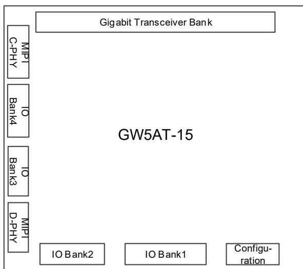
每个 Bank 有独立的 I/O 电源  $V_{CCIO}$ 。 $V_{CCIO}$  可以设置为 3.3V、2.5V、1.8V、1.5V、1.35V 或 1.2V。器件的辅助电压  $V_{CCX}$  供电电压为 1.8V、2.5V 或 3.3V。
