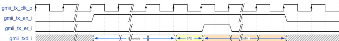
图 3-13 10M/100M 速率错误以太网帧发送
