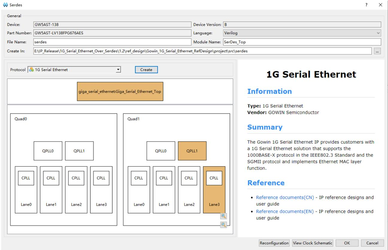
然后，点击界面右下角的“OK”按钮，可生成 SerDes IP 相关文件，完成整个 1G Serial Ethernet IP 的生成过程。
