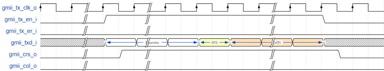
图 3-19 1000M 速率发送冲突
