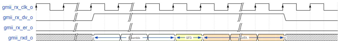
图 3-3 10M/100M 速率正常以太网帧接收
