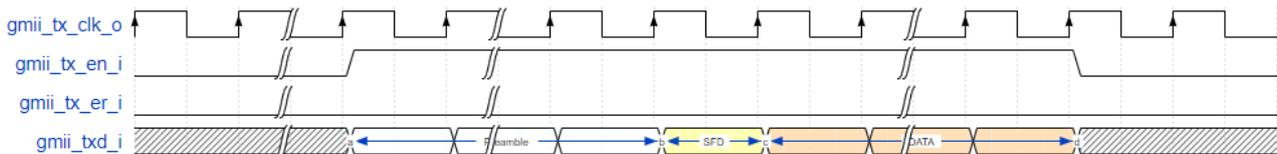
图 3-11 10M/100M 速率正常以太网帧发送
