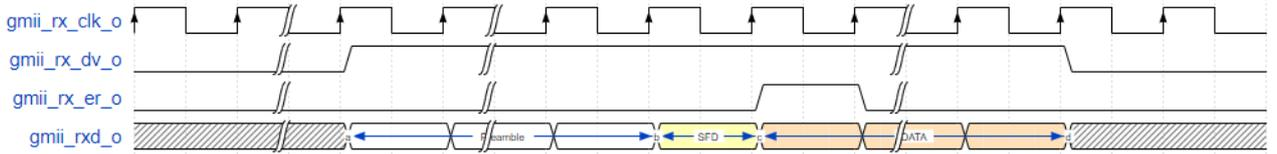
图 3-5 10M/100M 速率错误以太网帧接收
