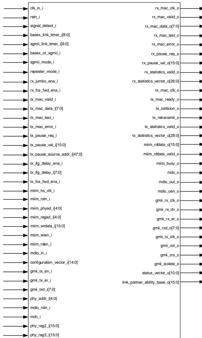
表 4-1 Gowin 1G Serial Ethernet IP IO 端口
