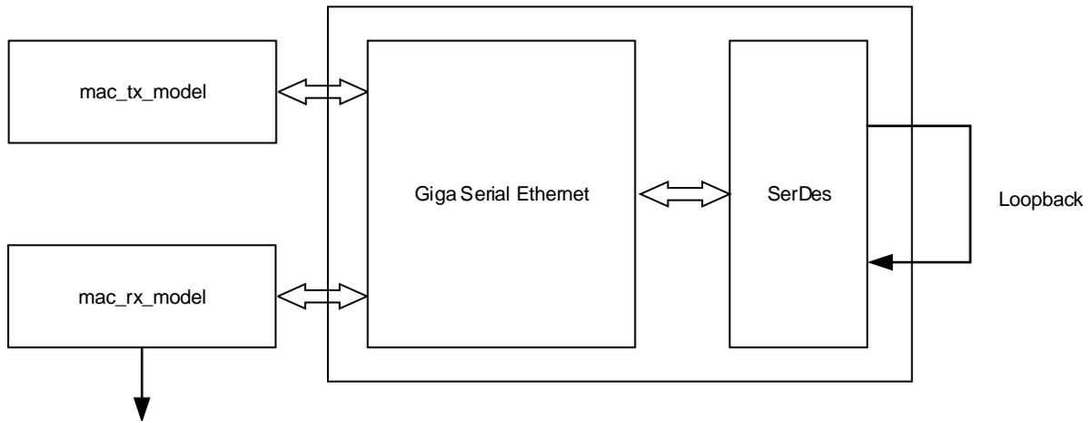
将 SerDes 的传输通道设置为环回模式，Giga Serial Ethernet 接收来自于 mac\_tx\_model 的传输数据，通过 SerDes 的 TX 接口环回到 SerDes 的 RX 接口，最终 Giga Serial Ethernet 再将环回的数据送给 mac\_rx\_model。主要模块如下：
