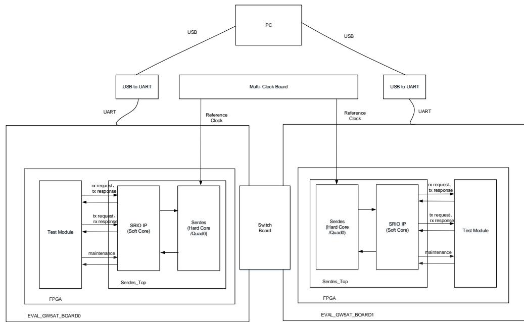
由于用户进行的是两块开发板的对接测试，所以需要更改参考设计 IP GUI 界面的环回设置，将选项“Loopback Mode”设置为 OFF 表示正常对接模式。
