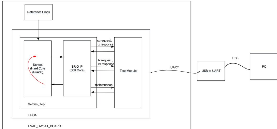
PC 通过串口工具可访问参考设计的 testreg 模块寄存器和 Serial RapidIO IP 寄存器和远端设备的寄存器。testreg 的地址空间为 0x000000~0x3ffffc(字节地址), Serial RapidIO IP 本地设备的地址空间为 0x400000~0x5ffffc(字节地址), Serial RapidIO IP 远端设备的地址空间为 0x600000~0x7ffffc(字节地址)。
