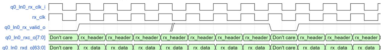
图 3-15 为接收数据时序。当 q0\_In0\_rx\_valid\_o 为 1 时，rx\_header 和 rx\_data 有效；当 q0\_In0\_rx\_valid\_o 为 0 时，rx\_header 和 rx\_data 无效。
