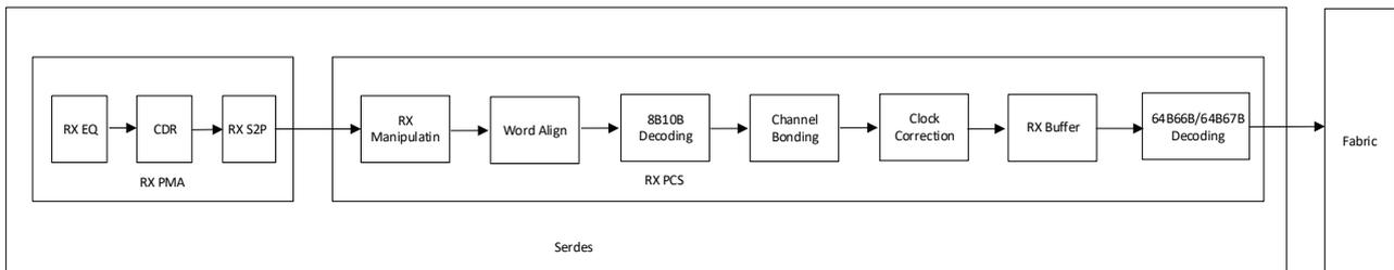
如图 3-4 所示，SerDes 接收部分由以下 10 个模块组成，其中 64B66B/64B67B Decoding 模块仅 GW5AT-60 支持，RX PCS 中的模块均可独立 bypass。
