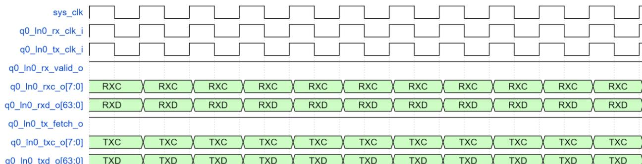
图 3-9 为 10GBASER with FIFO 模式时序图。 $q0\_In0\_rxc\_i$ 、 $q0\_In0\_rxd\_i$ 、 $q0\_In0\_txc\_o$ 、 $q0\_In0\_txd\_o$  均同步与  $sys\_clk$ 。
