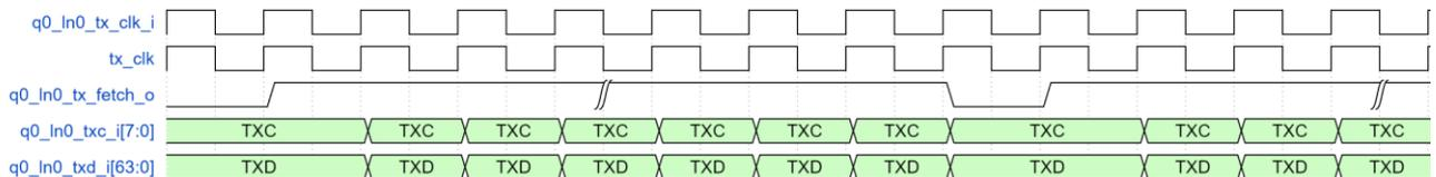
图 3-11 为发送数据时序。当 q0\_ln0\_tx\_fetch\_o 为 1 时，IP 获取 TXC 和 TXD；当 q0\_ln0\_tx\_fetch\_o 为 0 时，IP 不获取 TXC 和 TXD。用户需要确保发送的数据均在 q0\_ln0\_tx\_fetch\_o 为 1 时输入。
