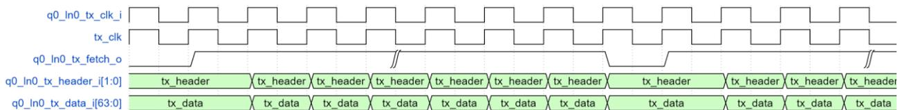
图 3-14 为发送数据时序。当 q0\_In0\_tx\_fetch\_o 为 1 时，IP 获取 tx\_header 和 tx\_data；当 q0\_In0\_tx\_fetch\_o 为 0 时，IP 不获取 tx\_header 和 tx\_data。用户需要确保发送的数据均在 q0\_In0\_tx\_fetch\_o 为 1 时输入。
