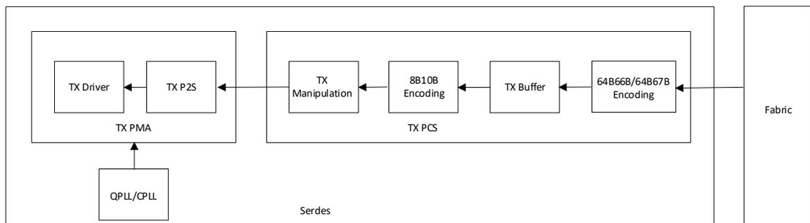
如上图所示，SerDes 发送部分由以下 6 个模块组成，其中 64B66B/64B67B Encoding 模块仅 GW5AT-60 支持，TX PCS 中的模块均可独立 bypass。
