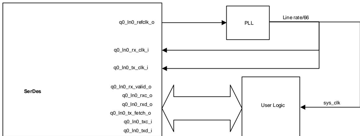
如图 3-8 所示，以  $q0\_In0$  时钟为例， $q0\_In0\_refclk\_o$  输出时钟频率与输入参考时钟相关（等于参考时钟或是参考时钟的  $n$  分频）。用户可在工程中例化 PLL， $q0\_In0\_refclk\_o$  经过 PLL 输出 Line rate/66 频率时钟作为  $q0\_In0\_rx\_clk\_i$  和  $q0\_In0\_tx\_clk\_i$  输入时钟，同时可作为  $sys\_clk$  驱动用户逻辑。此时，64B66B 相关信号均同步于  $sys\_clk$ 。此种时钟结构下， $q0\_In0\_tx\_fetch\_o$  和  $q0\_In0\_rx\_valid\_o$  为常 1。
