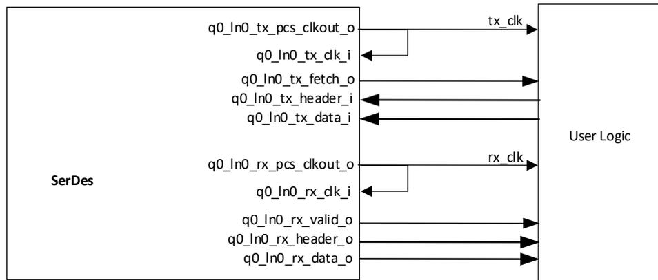
以 q0\_In0 为例，时钟结构如图 3-13 所示，发送数据同步与 tx\_clk，接收数据同步与 rx\_clk。
