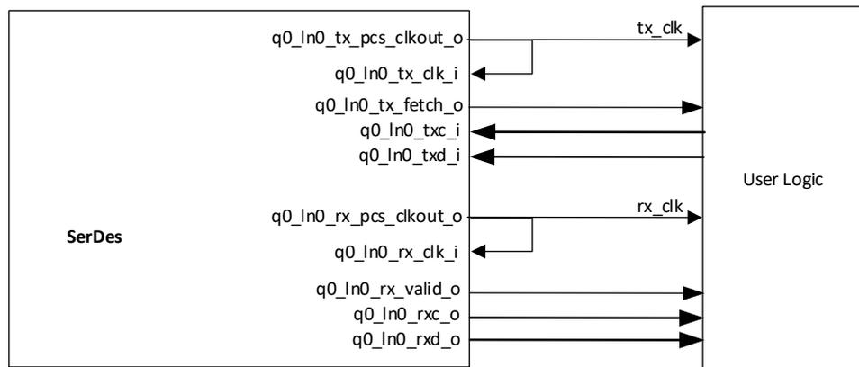
以 q0\_ln0 为例，时钟结构如图 3-10 所示，发送数据同步与 tx\_clk，接收数据同步与 rx\_clk。
