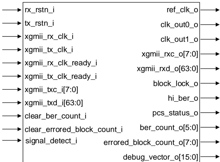
对于 GW5AT-60/15 产品，Gowin 10G Serial Ethernet IP 的 IO 端口如图 4-2 所示。
