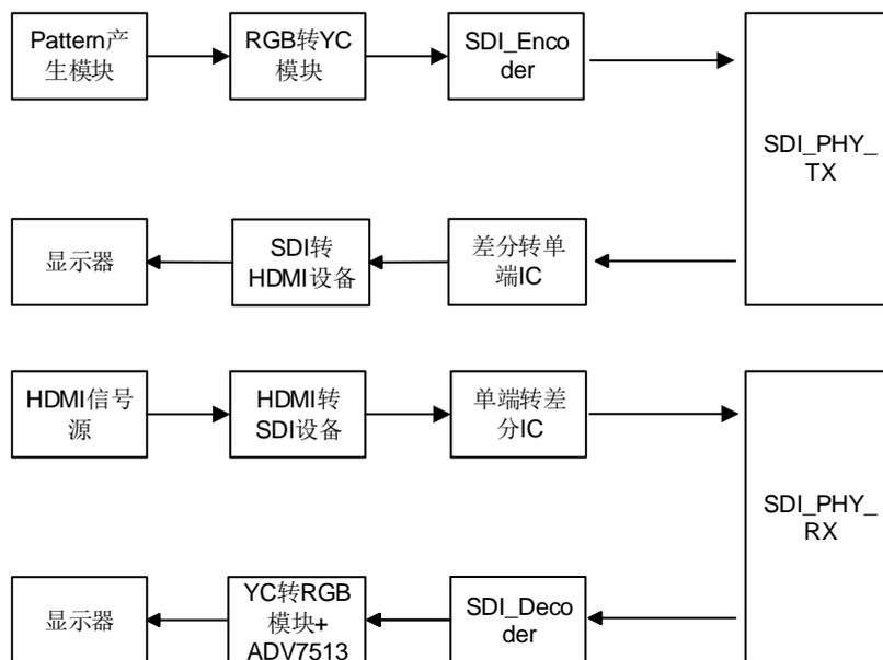
在参考设计中，采用的是 TX 和 RX 各自独立验证的方式。TX 通过 Pattern 产生模块产生测试图视频信号，输出到 SDI\_PHY\_TX，然后 SerDes 差分输出到差分转单端 IC，再到 SDI 物理接口，再输出到 SDI 转 HDMI 设备，最终到显示器。SDI\_PHY\_RX 则通过单端转差分 IC 接收信号源的视频信号，然后输出给 ADV7513，最终给到显示器。
