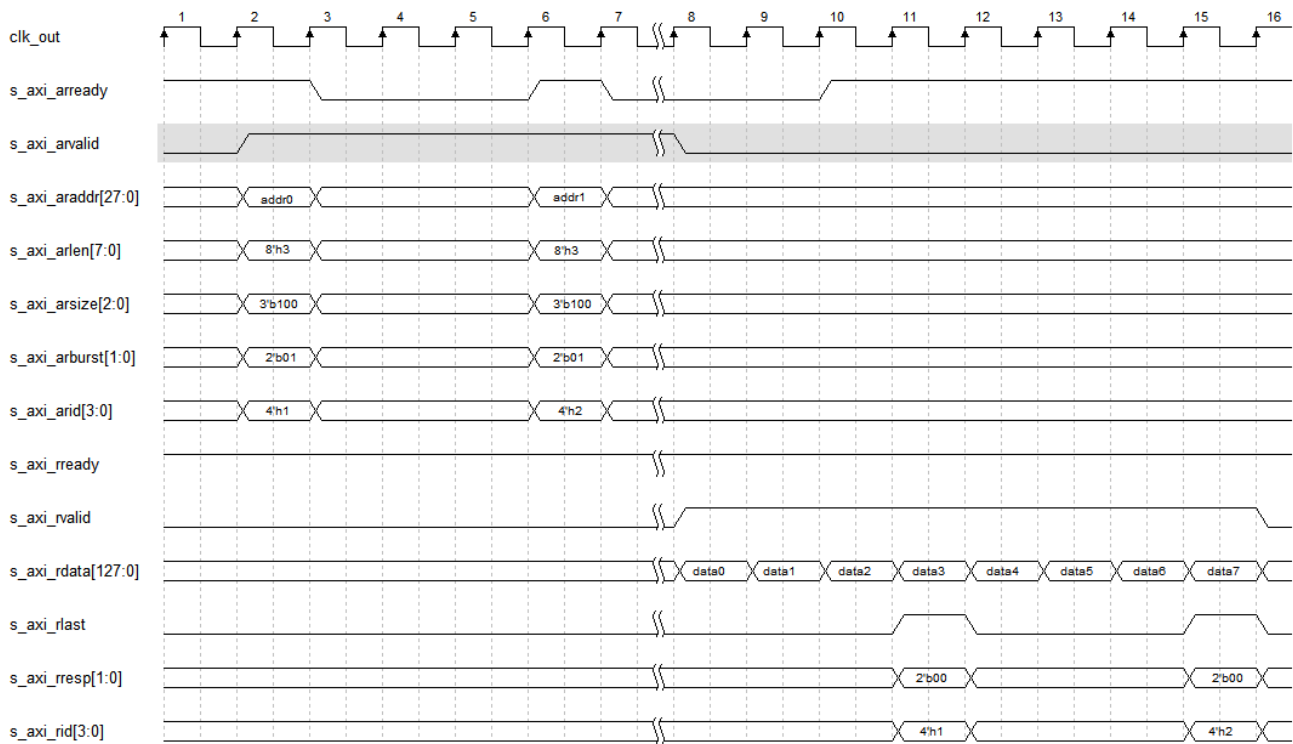
図 4-20 AXI4 読み出しチャンネルのタイミング
