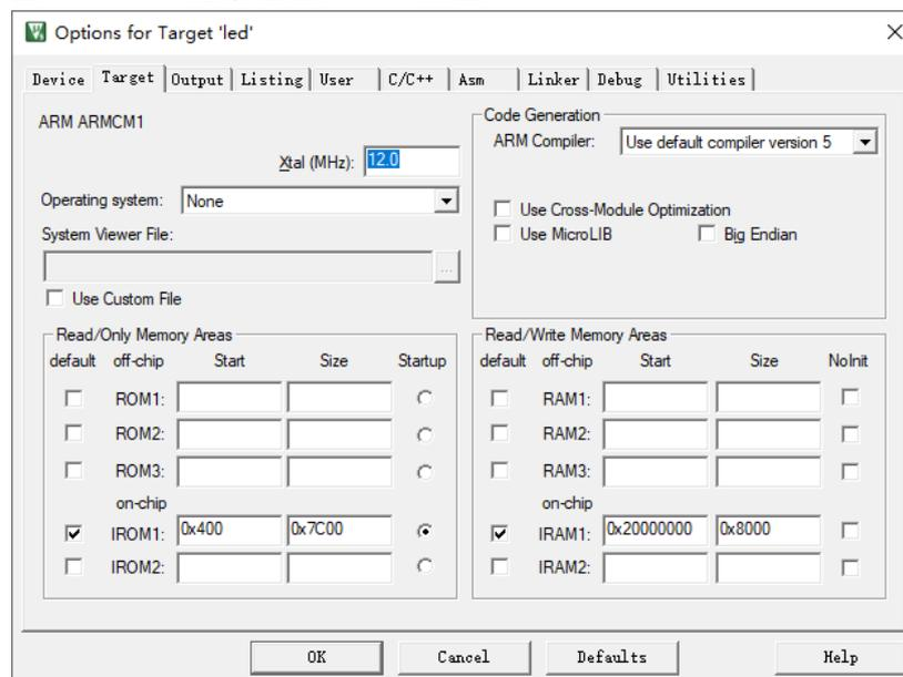
如果使用 GMD（已测试软件版本：V1.2）软件开发环境，选用 Flash 链接器 GOWIN\_M1\_flash\_burn.ld，Flash 起始地址“FLASH ORIGIN”为 0x00000400。
