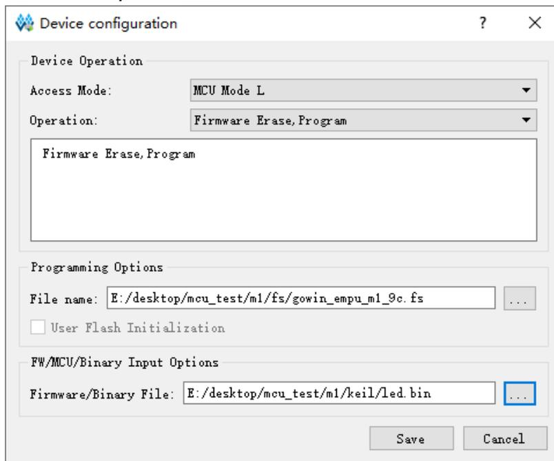
完成 Device configuration 后，单击 Programmer 工具栏 “Program/Configure” (▶)，同时下载硬件设计码流文件和软件编程设计 Binary 文件。
