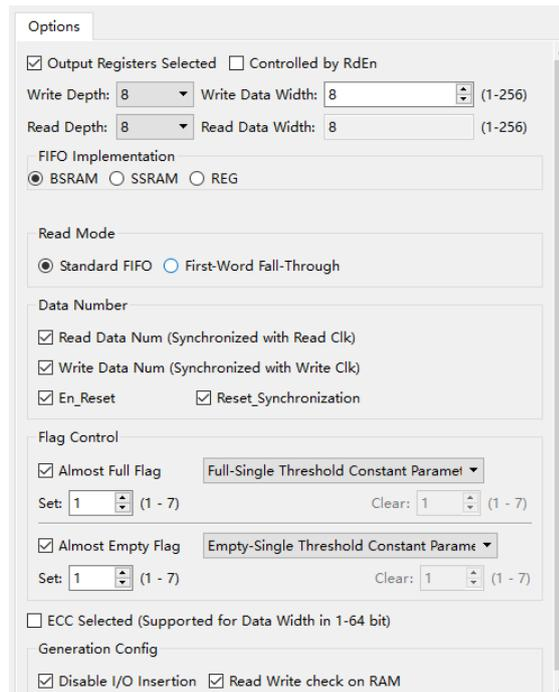
如图 4-4 所示，在图 4-3 的配置中，选择输出寄存器功能，即将输出寄存一级再输出，所以读出的数据较不配置输出寄存器时晚一个周期，且最后一个数据会输出。
