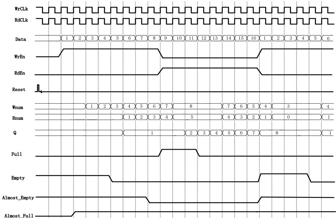
图 4-12 为 FIFO HS 在图 4-11 所示的配置下的一次读写操作示例。
