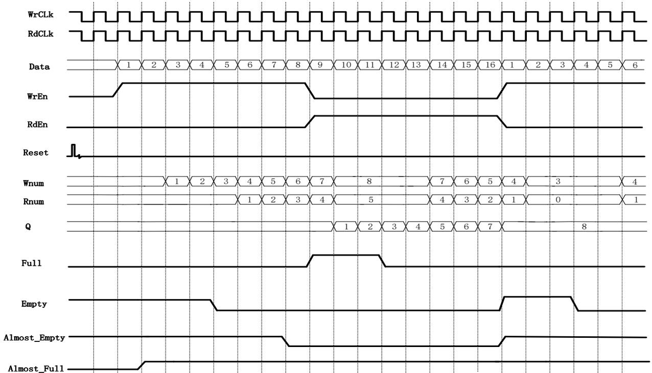
图 4-4 为 FIFO HS 在图 4-3 所示的配置下的一次读写操作示例。
