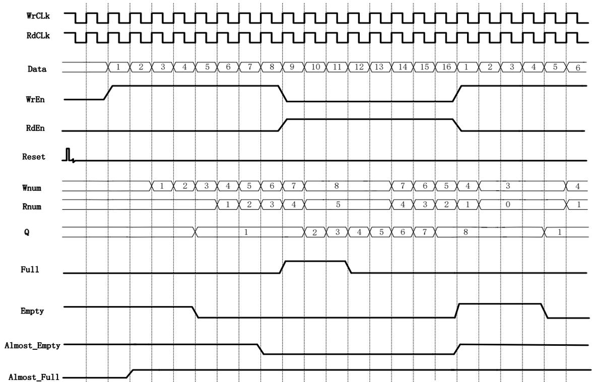
图 4-10 为 FIFO HS 在图 4-9 所示的配置下的一次读写操作示例。
