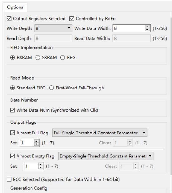
如图 4-18 所示，在图 4-17 的配置中，选择输出寄存器功能且选择读使能控制，即输出寄存器受 RdEn 控制，所以读出的数据较不配置输出寄存器时晚一个周期，且最后一个数据不会在第一个读使能下输出，这个数据将会成为下一个读使能的第一个数据输出。
