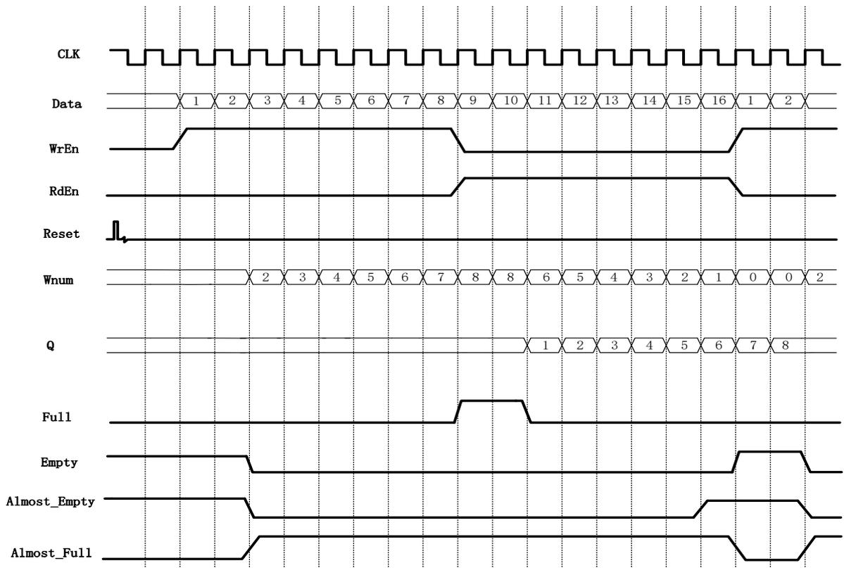
图 4-18 为 FIFO SC HS 在图 4-17 所示的配置下的一次读写操作示例。
