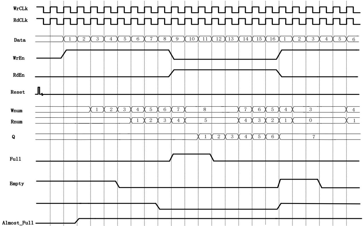
图 4-8 为 FIFO HS 在图 4-7 所示的配置下的一次读写操作示例。
