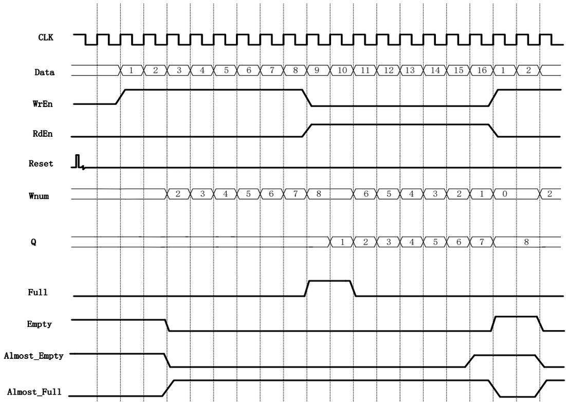
图 4-16 为 FIFO SC HS 在图 4-15 所示的配置下的一次读写操作示例。
