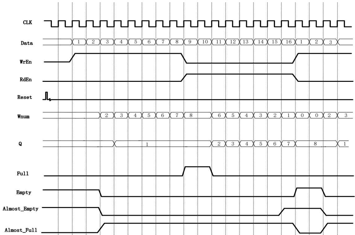
图 4-24 为 FIFO SC HS 在图 4-23 所示的配置下的一次读写操作示例。
