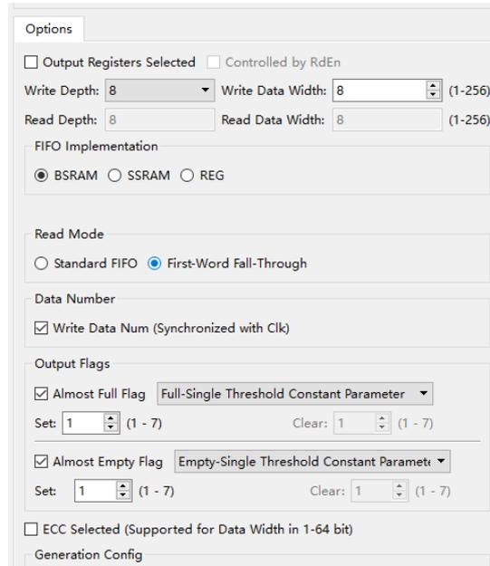
如图 4-20 所示，在图 4-19 的配置中，选择 FIFO SC HS IP 的 FWFT 模式，即 First-Word Fall-Through，在 FIFO 为非空状态时，不管是否有读使能信号，都会将写入的第一个数马上放在输出数据总线上，当读使能拉高后会按顺序输出写入的其他数据。
