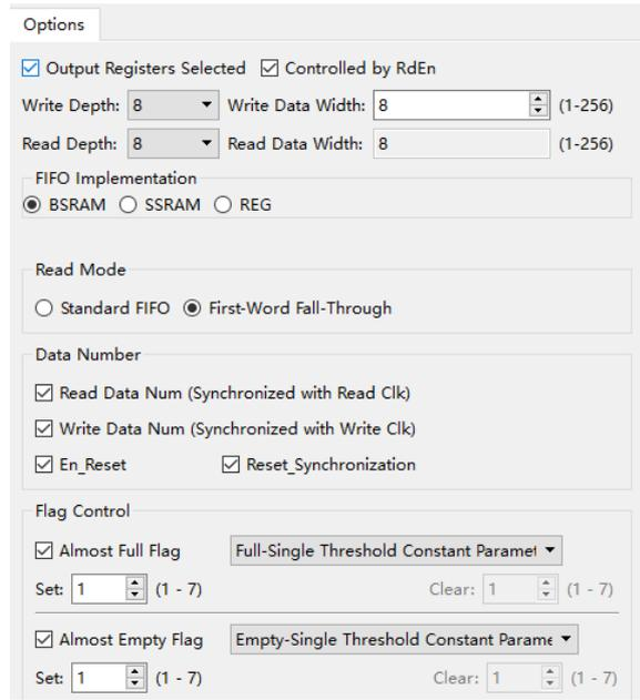
如图 4-12 所示, 在图 4-11 的配置中, 选择 FIFO HS IP 的 FWFT 模式, 且选择输出寄存功能和读使能控制, 即将 FWFT 模式下 FIFO 的输出数据寄存一级, 但是在读使能的控制下输出。
