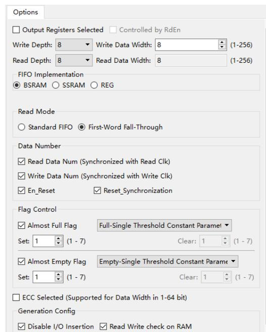
如图 4-8 所示，在图 4-7 的配置中，选择 FIFO HS IP 的 FWFT 模式，即 First-Word Fall-Through，在 FIFO 为非空状态时，不管是否有读使能信号，都会将写入的第一个数马上放在输出数据总线上，当读使能拉高后会按顺序输出写入的其他数据。
