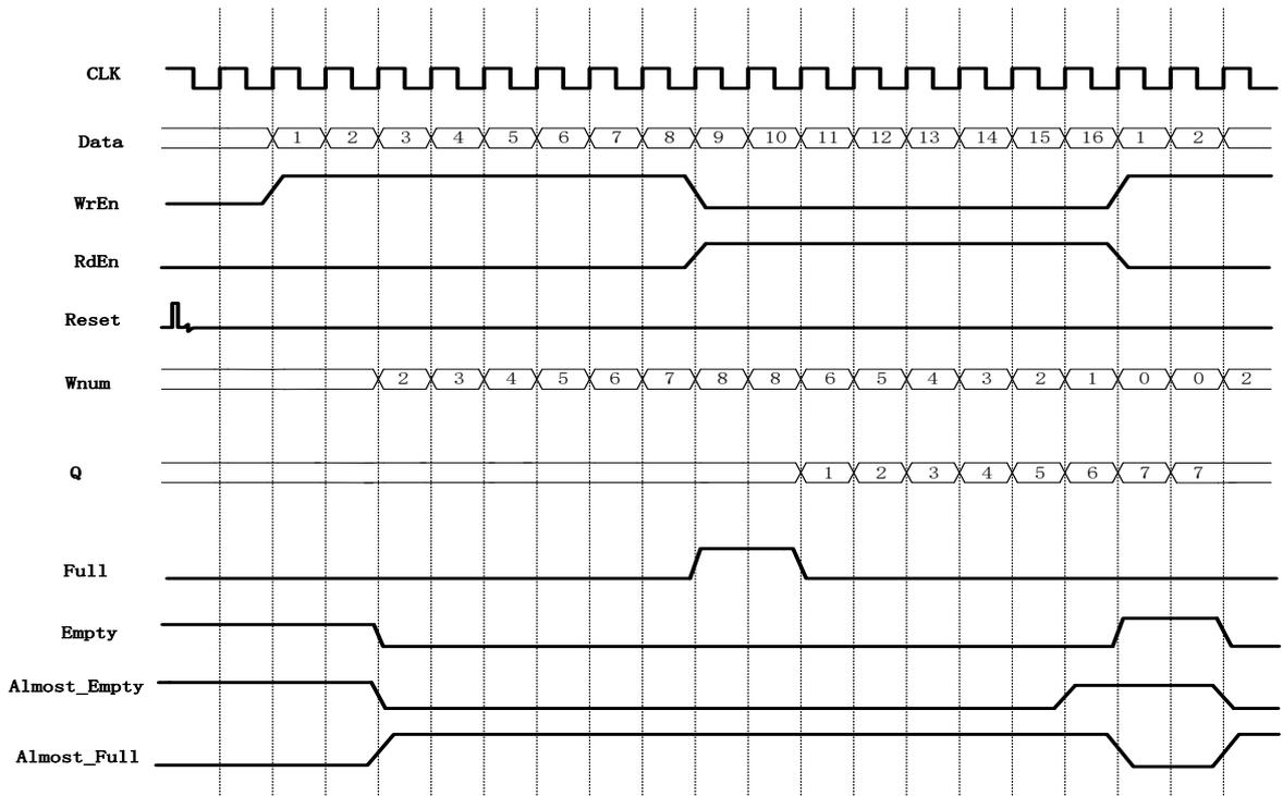
图 4-20 为 FIFO SC HS 在图 4-19 所示的配置下的一次读写操作示例。
