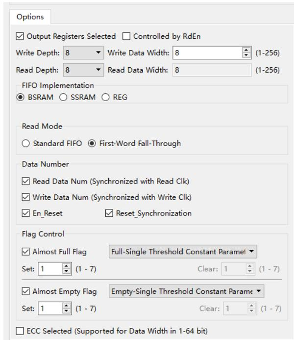
如图 4-10 所示，在图 4-9 的配置中，选择 FIFO HS IP 的 FWFT 模式，且选择输出寄存功能，即将 FWFT 模式下 FIFO 的输出数据寄存一级再输出。
