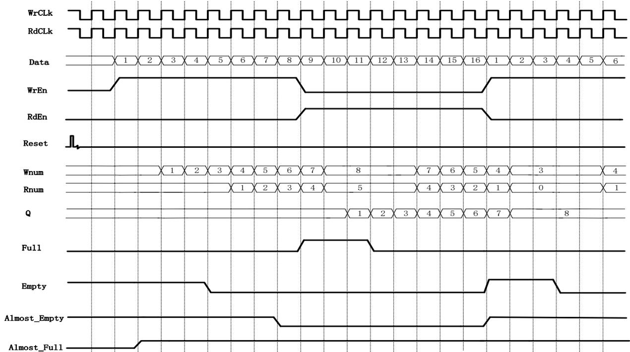
图 4-6 为 FIFO HS 在图 4-5 所示的配置下的一次读写操作示例。
