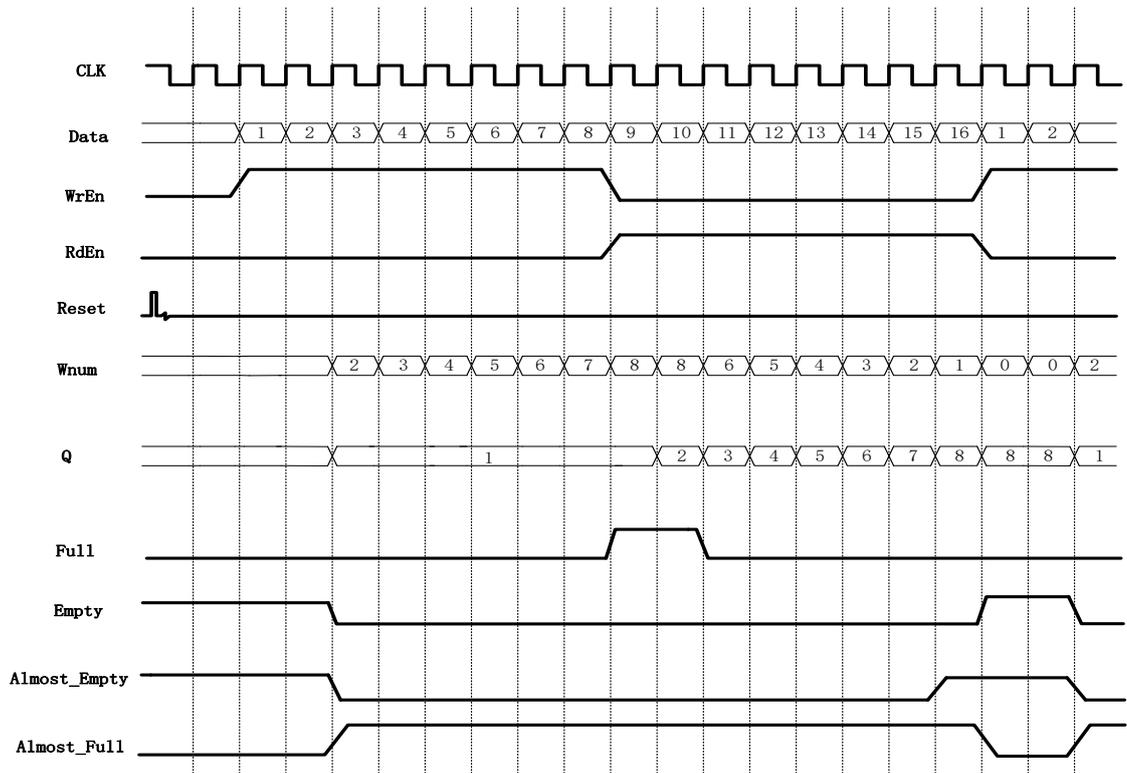
图 4-22 为 FIFO SC HS 在图 4-21 所示的配置下的一次读写操作示例。
