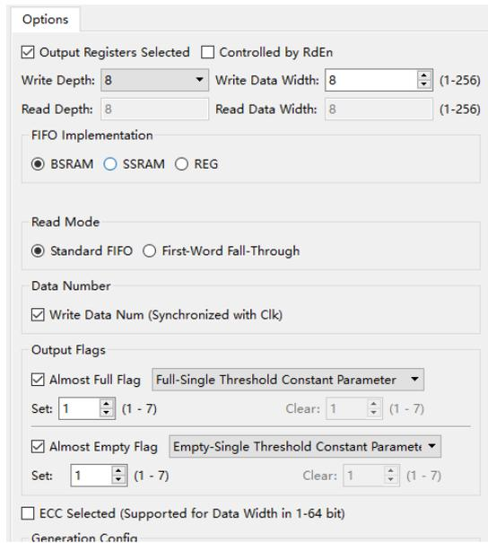
如图 4-16 所示，在图 4-15 的配置中，选择输出寄存器功能，即将输出寄存一级再输出，所以读出的数据较不配置输出寄存器时晚一个周期，且最后一个数据会输出。
