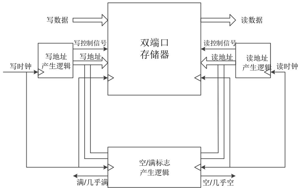
图 2-2 FIFO SC HS IP 结构示意图
