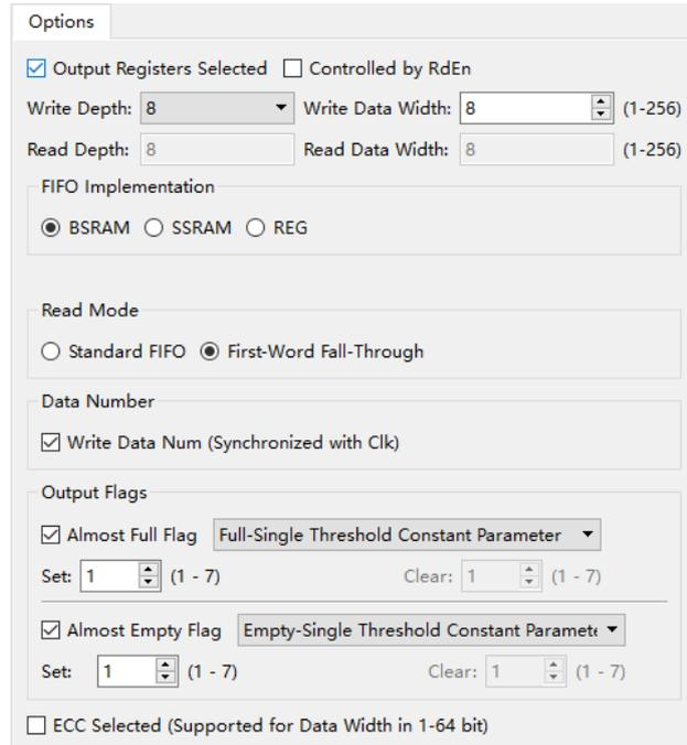
如图 4-22 所示，在图 4-21 的配置中，选择 FIFO SC HS IP 的 FWFT 模式，且选择输出寄存功能，即将 FWFT 模式下 FIFO 的输出数据寄存一级再输出。
