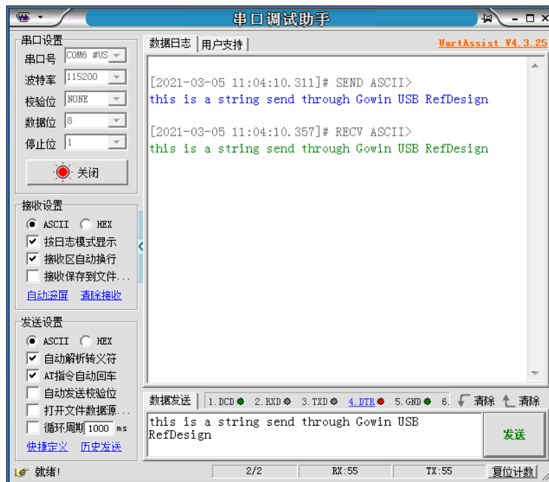
图 6-7 串口数据回环测试
