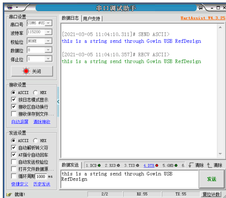
图 6-7 串口数据回环测试
