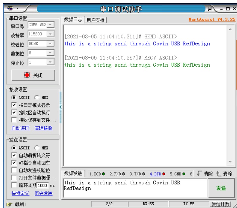
图 6-7 串口数据回环测试
