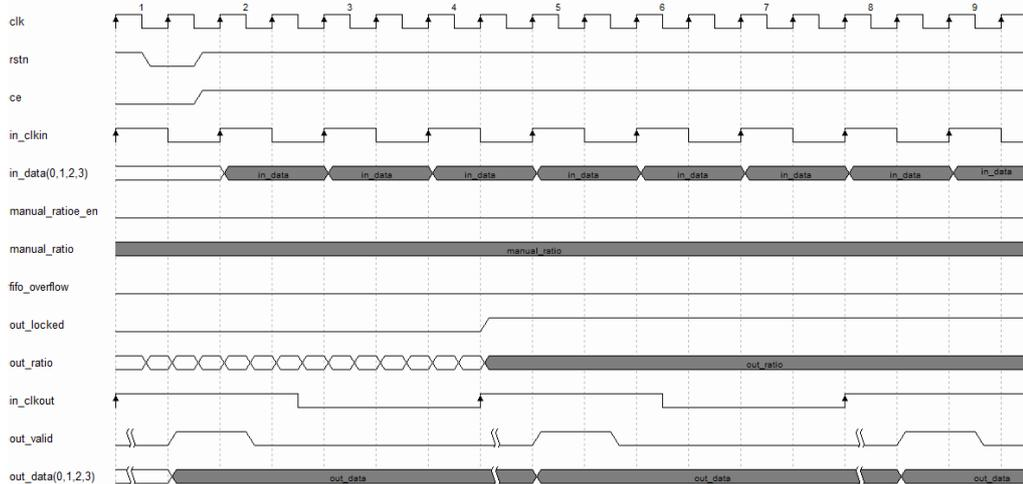
自动检测采样，是通过输入采样时钟(in\_clkln)和输出采样时钟(in\_clkout)进行采样率计算，处理后得到输出采样率(out\_ratio)。当锁信号(out\_locked)为高电平，输出采样率稳定。
