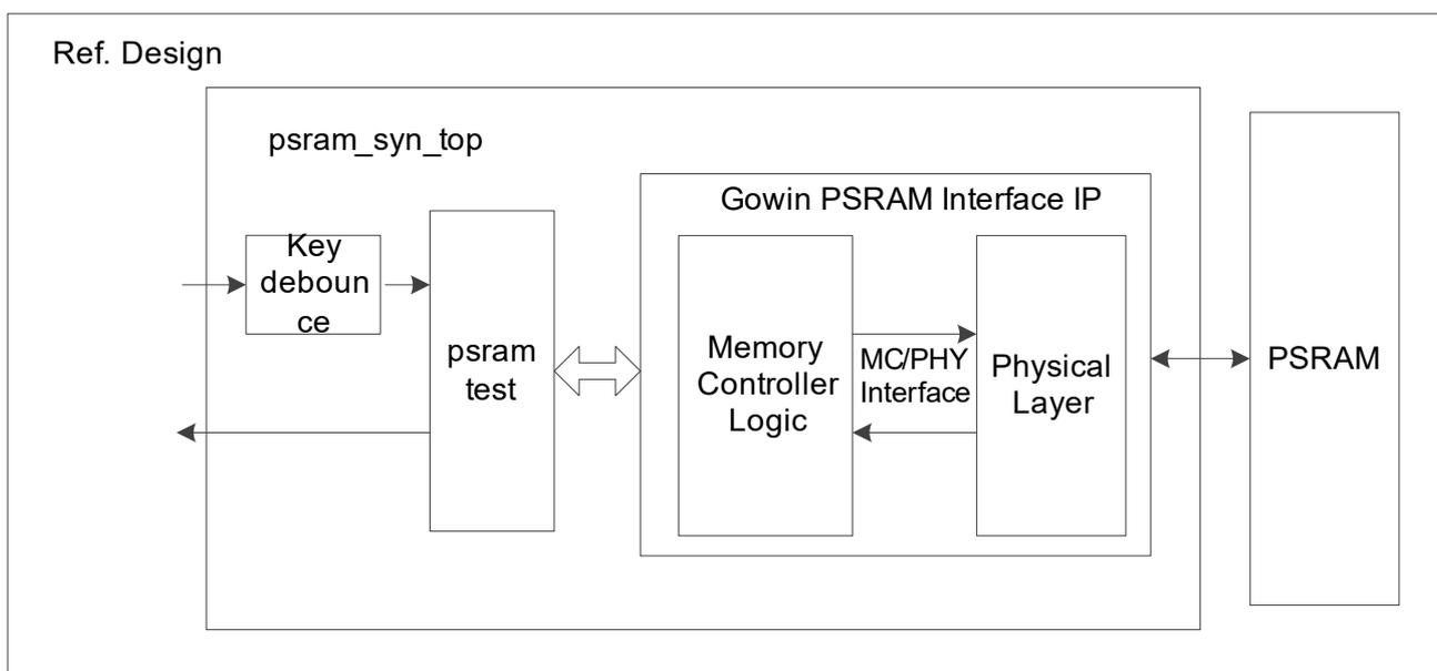
在参考设计中，psram\_syn\_top 模块是顶层模块单元，其端口连接输入参考时钟、外部复位等信号，端口连接如表 8-1 所示。psram\_test 用于产生 Gowin PSRAM Interface HS IP 所需的地址、数据与读写等命令，并且该模块单元可综合。Key\_debounce 模块是一个消抖模块，用于消除由按键或拨码开关控制外部激励时产生的信号抖动。
