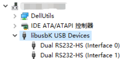
图 6-5 检查设备管理器（双通道）
