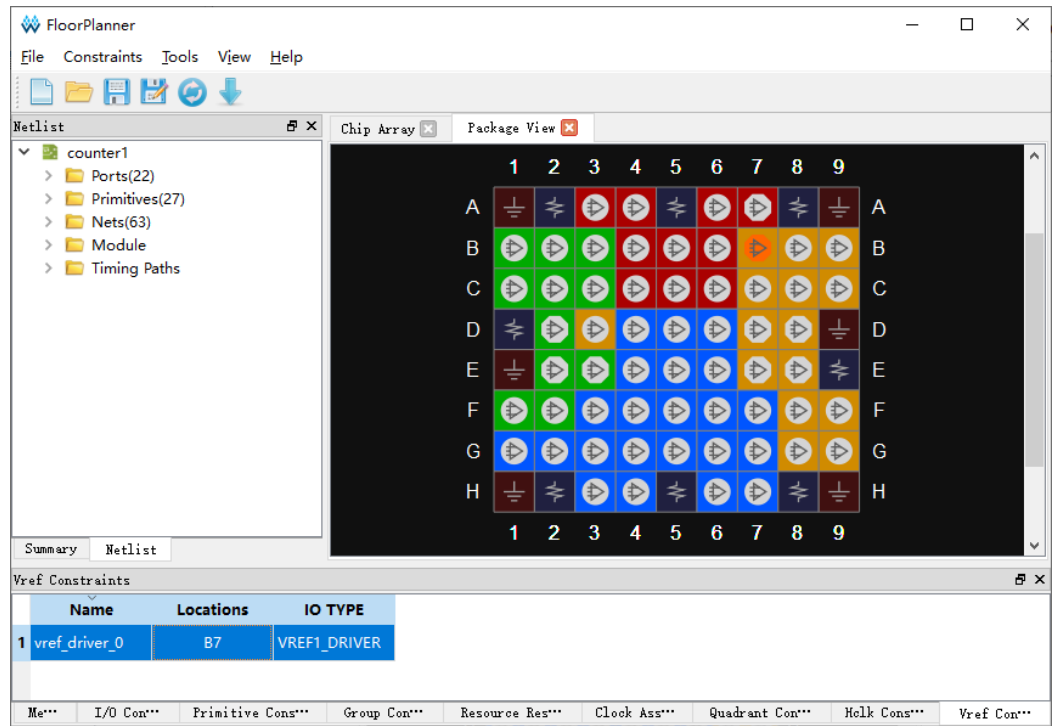
图 4-23 拖拽至 Package View 窗口生成 Vref Constraints Location 信息
