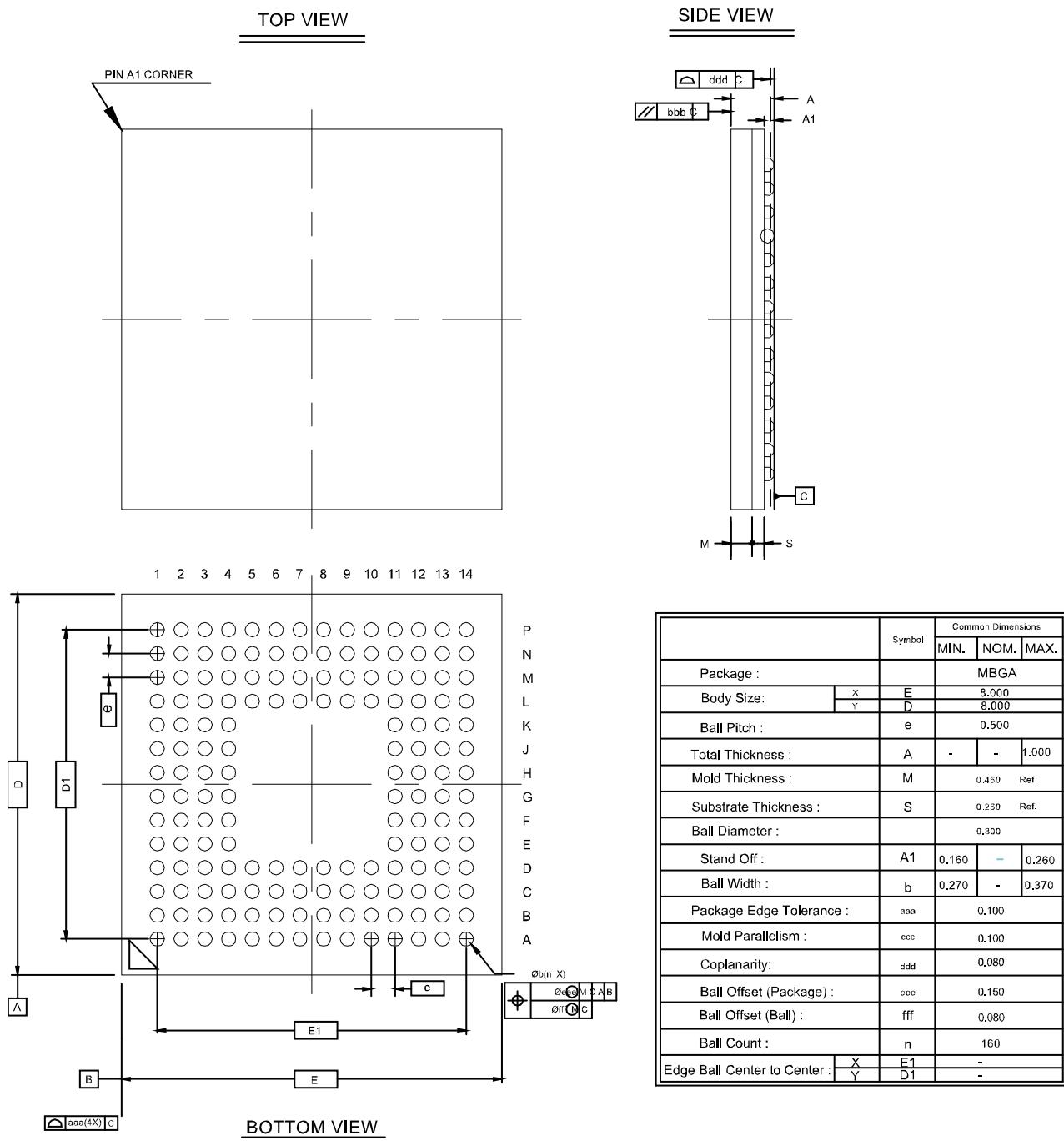
图 4-50 推荐 PCB Layout MG160
